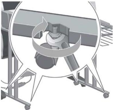
2. Ajuste a altura do empilhador girando a porca hexagonal inferior no sentido horário ou anti-horário.
