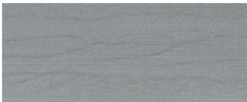
Aeroworms são faixas onduladas horizontais produzidas por erro de posicionamento de pontos induzido pelo ar (DPE). Em casos extremos, os aeroworms dão origem a uma imagem com aparência de fibra de madeira. O problema ocorre mais comumente em trabalhos de impressão definidos para baixa qualidade e alta velocidade. Ele não ocorre quando a configuração de qualidade de impressão personalizada está definida como “melhor”.
