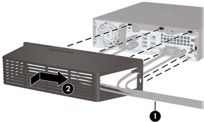
Figure 2-21 Installation d'un cache de port
