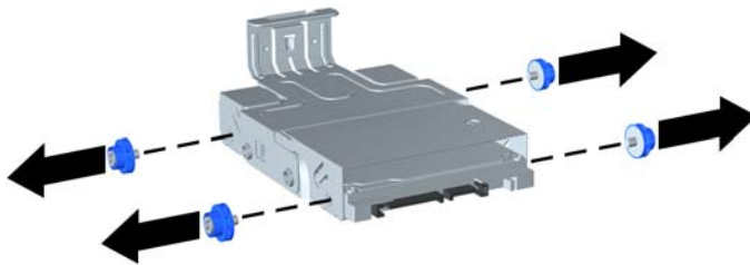
Figure 2-16 Retrait des vis de guidage
