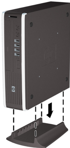
Figure 2-7 Placement de l'ordinateur sur le socle
