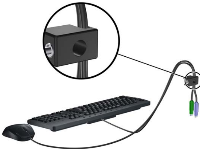
Figure C-5 Passage des câbles du clavier et de la souris
