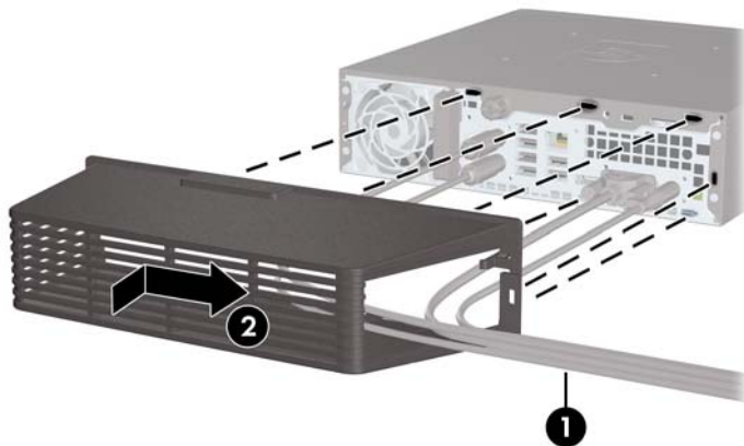
Afbeelding 2-21 Afdekkapje voor de poorten installeren
