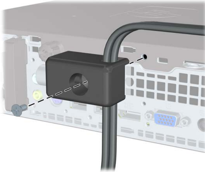
Afbeelding C-6 Slot aan het chassis bevestigen
