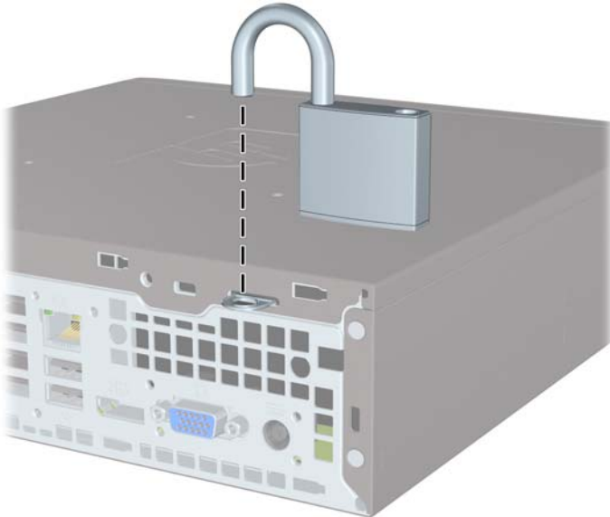
Figura C-3 Instalación de un candado
