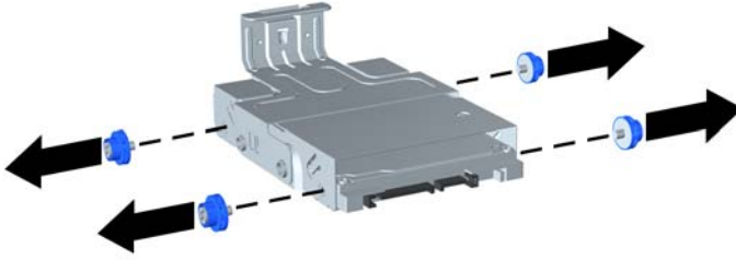
Figura 2-16 Extracción de los tornillos guía
