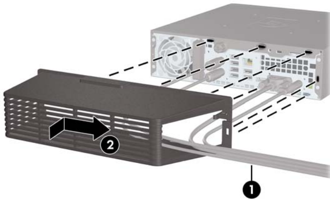
Figura 2-21 Instalación de una cubierta para puerto
