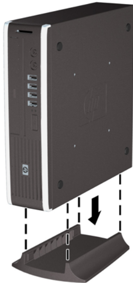
Figura 2-7 Colocación del equipo en la base
