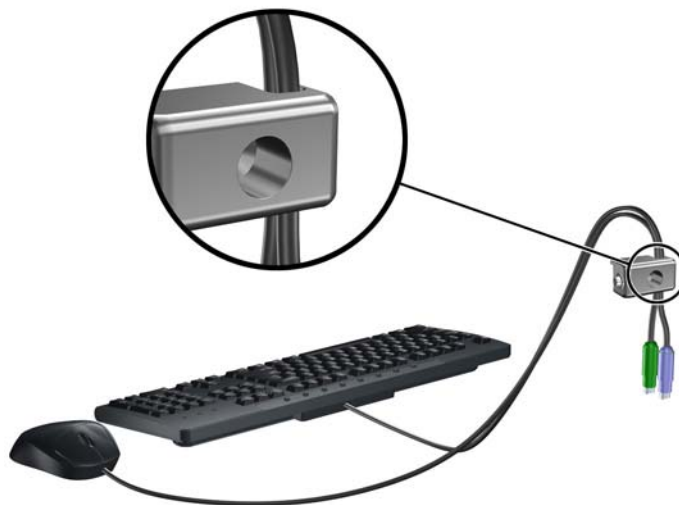
Figure B-7 Passage des câbles du clavier et de la souris
