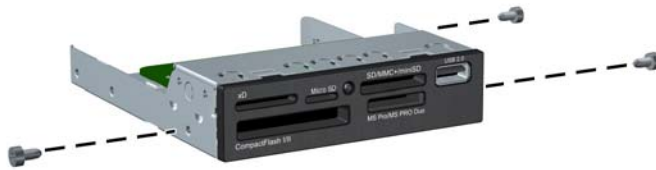
Figure 2-32 Installation des vis de montage dans les lecteurs de cartes multimédias
