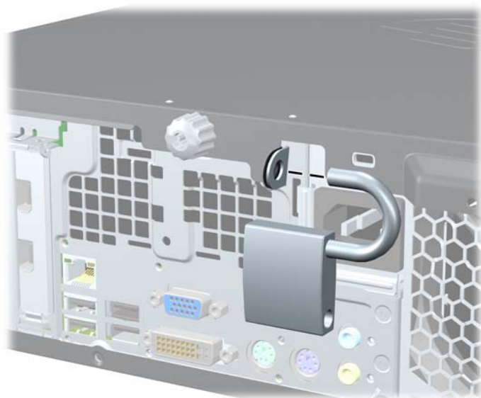
Figure B-2 Installation d'un cadenas
