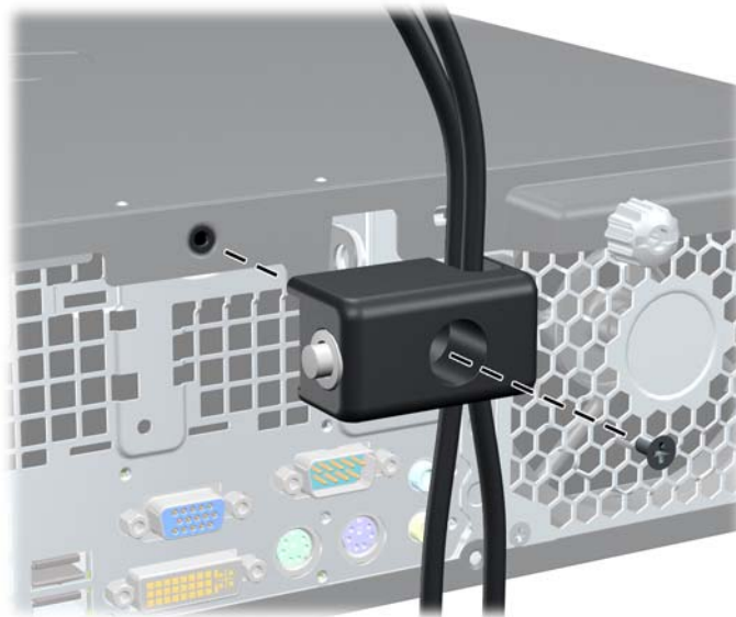
Figure B-9 Fixation du verrou sur le châssis
