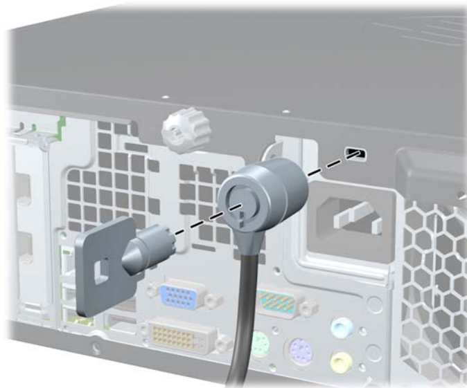
Figure B-1 Installation d'un câble de sécurité
