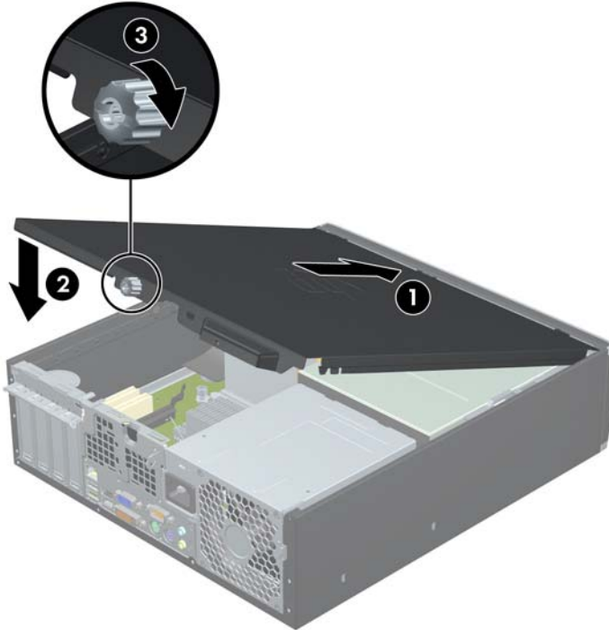
Figure 2-2 Remise en position du panneau d'accès
