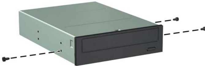
Figure 2-23 Installation des vis de montage dans l'unité optique
