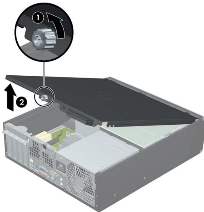
Bild 2-1 Ta bort åtkomstpanelen
