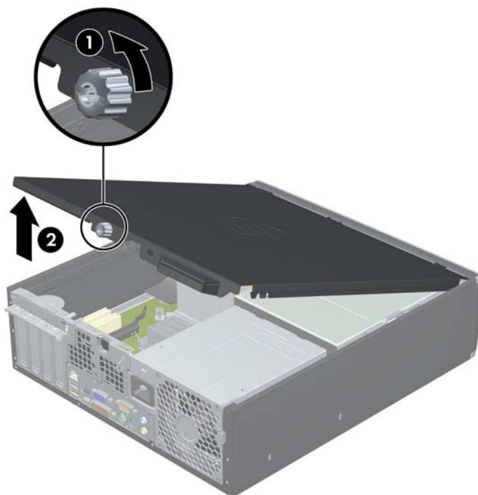
Obrázek 2-1 Sejmутí přístupového krytu
