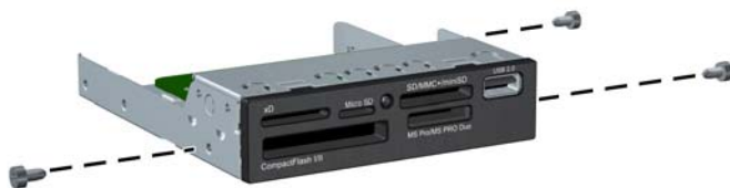
Rysunek 2-32 Instalowanie śrub mocujących w czytniku kart pamięci
