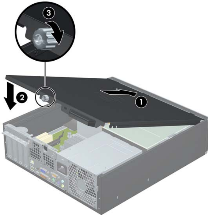
Rysunek 2-2 Zakładanie panelu dostępu
