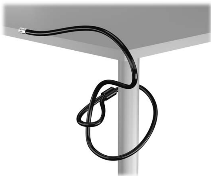
Rysunek B-3 Przymocowanie linki do nieruchomego obiektu
