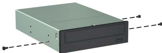
Rysunek 2-23 Instalowanie śrub mocujących w napędzie optycznym
