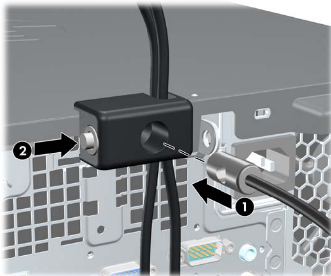
Slika B-10 Zaklepanje ključavnice
