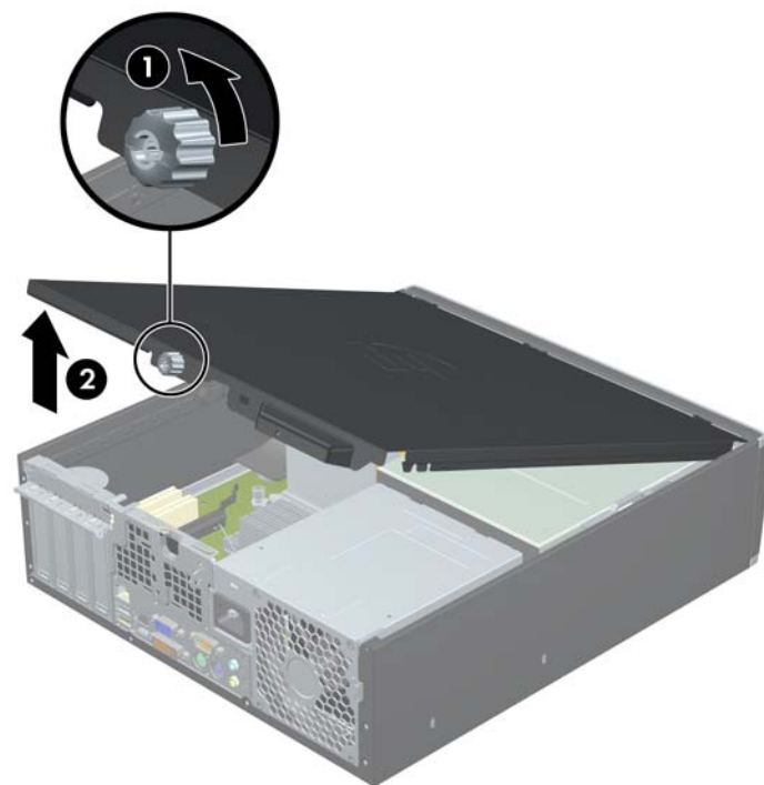
Slika 2-1 Odstranitev dostopnega pokrova
