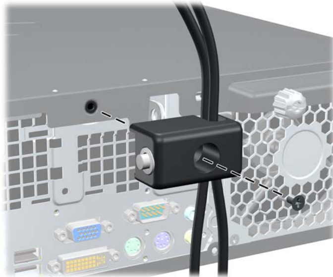
Slika B-9 Namestitev ključavnice na ohišje
