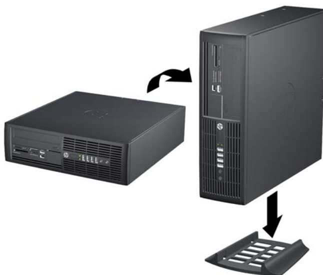
Slika 2-6 Sprememba iz namiznega ohišja v stolp
