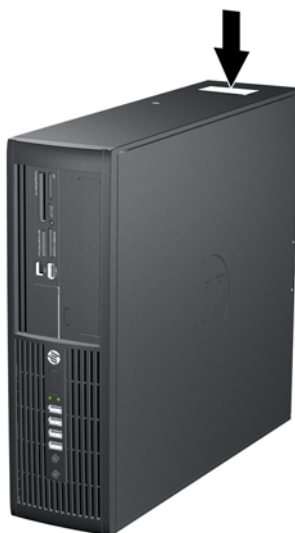
Slika 1-6 Mesto serijske številke in identifikacijske številke izdelka
