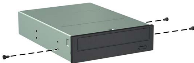
Slika 2-23 Namestitev pritrdilnih vijakov na optični pogon
