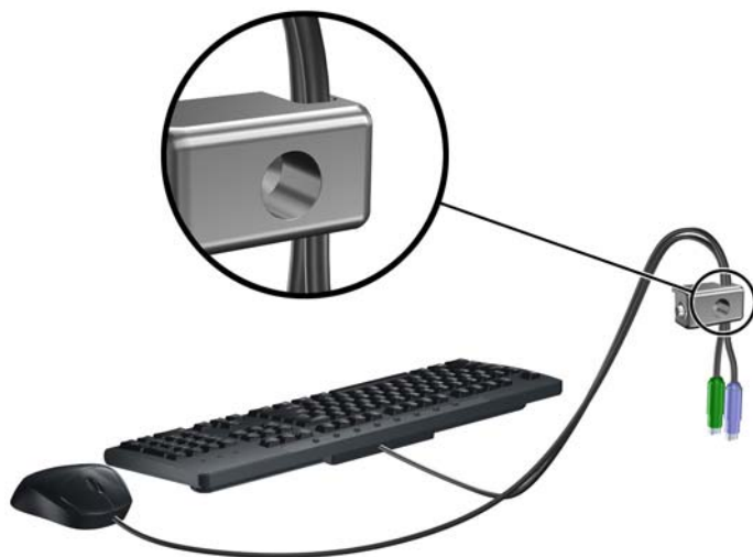
Slika B-7 Napeljava kablů tipkovnice in miške
