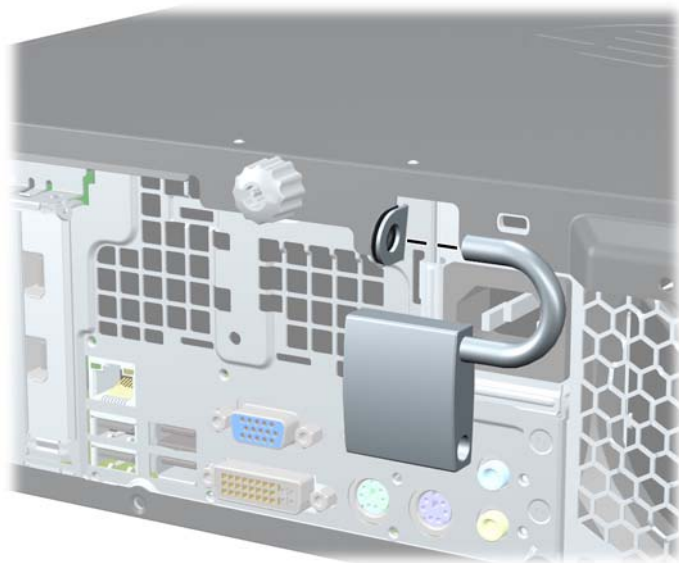
Slika B-2 Ugradnja sigurnosnog lokota
