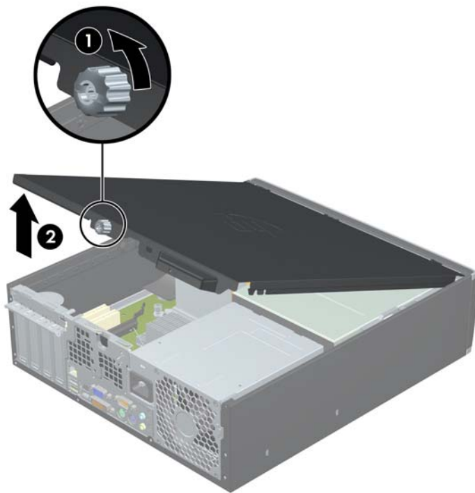
Slika 2-1 Skidanje pristupne ploče
