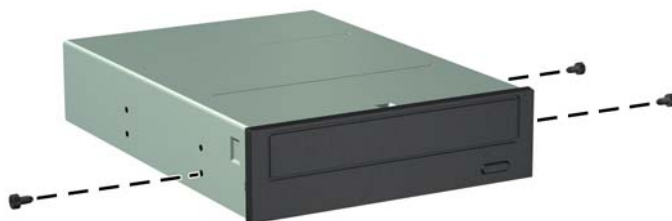
Figura 2-23 Instalación de tornillos de montaje en la unidad óptica
