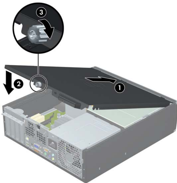
Figura 2-2 Reinstalación del panel de acceso
