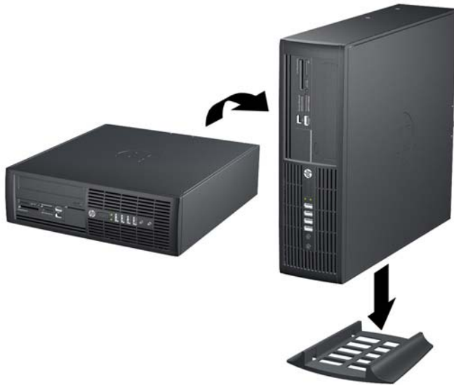
Figura 2-6 Cambio de configuración de desktop para torre
