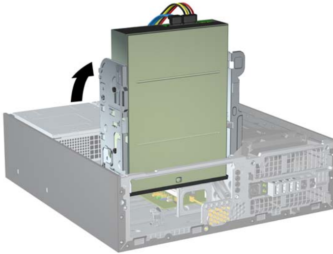
Figura 2-8 Giro del compartimiento para unidades a la posición vertical
