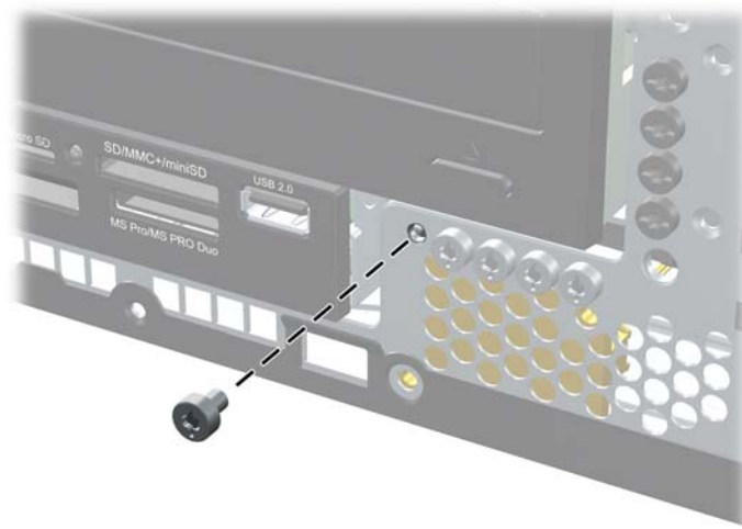
Figura B-12 Extracción del tornillo de seguridad del panel frontal
