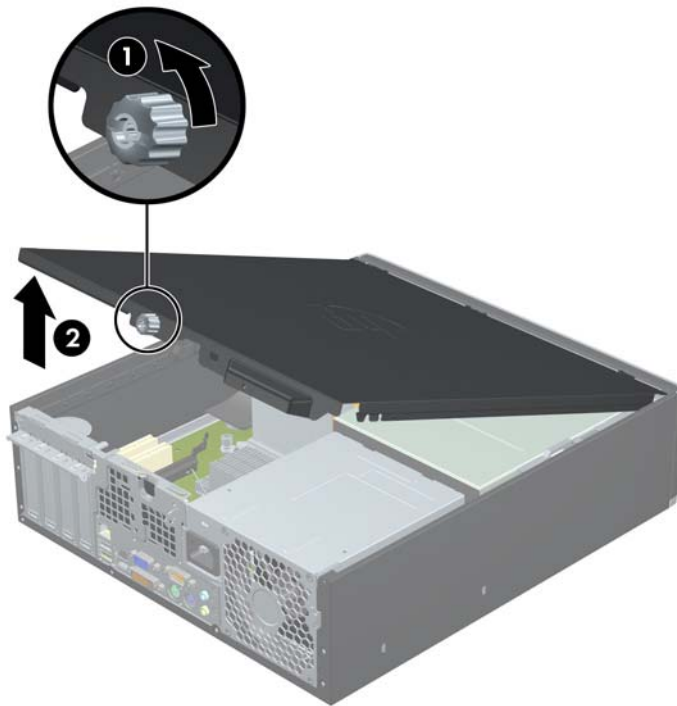
Figura 2-1 Extracción del panel de acceso
