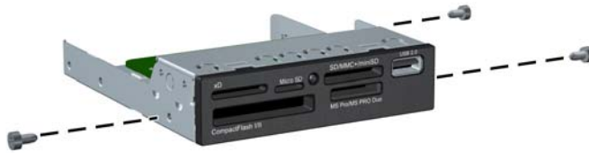
Figura 2-32 Instalación de tornillos de montaje en el lector de tarjetas multimedia
