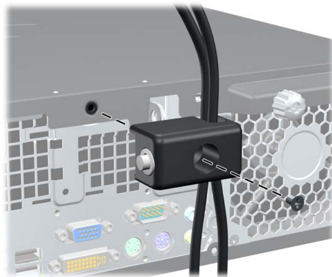
Figura B-9 Acoplado del bloqueo al chasis
