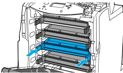
Ta tak i de blå håndtakene på hver side av skriverkassetten. Juster skriverkassetten slik at den står på linje med sporene på innsiden av skriveren, og skyv kassetten inn til den klikker på plass.
