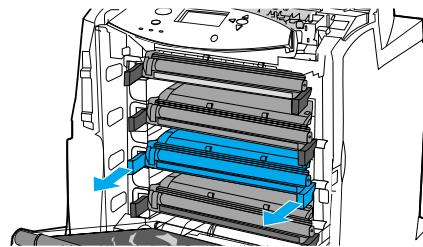
Kullanılmış baskı kartuşunun yan kısımlarındaki mavi tutacıkları kavrayın ve yazıcıdan çıkarmak için çekin.
