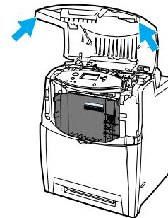
Bruk håndtakene på hver side for å åpne det øvre dekselet.
