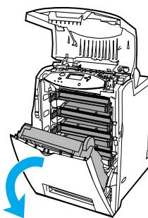
Ta tak i det grønne håndtaket på overføringsenheten og trekk det ned. Frontdekselet åpnes når overføringsenheten trekkes ned.
