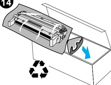
Nå er installeringen ferdig. Legg den brukte skriverkassetten i esken den nye kassetten ble levert i. I vedlagte resirkuleringsveiledning finner du instrksjoner for resirkulering.
