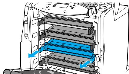
Ta tak i de blå håndtakene på hver side av den brukte skriverkassetten og trekk den ned for å ta kassetten ut av skriveren.
