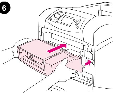
將信封進紙器平穩地插入印表機，直至其鎖定到位。向外拉動信封進紙器，以確定其穩固定位。
