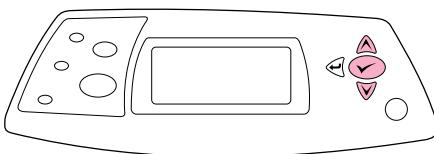
Når der vises en meddeelse om konvolutformatet i kontrolpanelets display, skal du bruge tasterne **▲** og **▼** for at vælge det korrekte konvolutformat og derefter trykke på **✓** for at gemme indstillingen.
