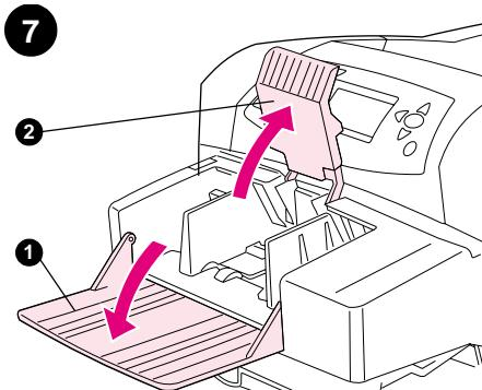
Fold konvolutfremførrens bakke ned (1). Løft konvolutvægten (2).
