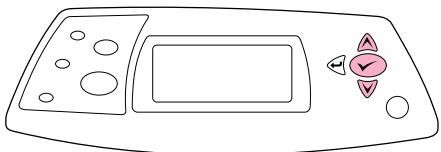
在控制面板顯示幕上出現信封尺寸提示時，使用 **▲** 與 **▼** 鍵來選擇正確的信封尺寸，然後按下 **✓** 以儲存該設定。
