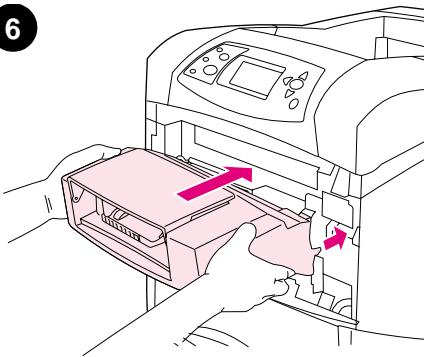
Sæt konvolutfremføreren helt ind i printeren, indtil den låser på plads. Træk ud i konvolutfremføreren for at sikre, at den sidder fast.
