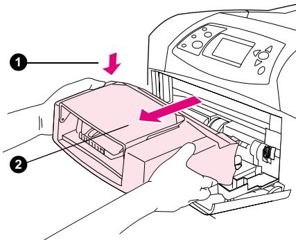
**Sådan fjernes konvolutfremføreren.** Tryk på konvolutfremførerens udløserknap (1), og træk konvolutfremføreren udad (2).
