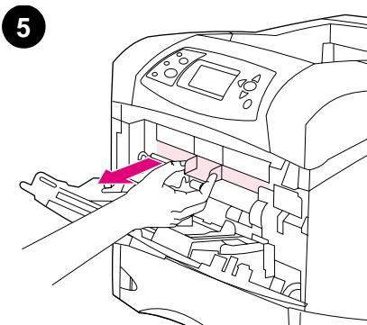
卸下印表機內部的塑料信封入口護蓋。**註：**在不安裝信封進紙器時，請裝回此入口護蓋。
