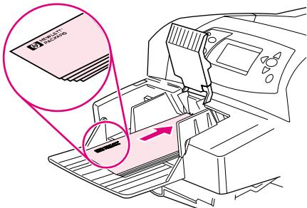
裝入信封，使有接縫的一面向下且貼郵票的一端朝向印表機。將信封儘量往前輕輕推入。
