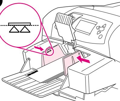
Juster styrene, således at de rører konvolutterne uden at bøje dem. **Bemærk!** Kontroller, at der ikke lægges flere konvolutterne i end op til pilene på styrene.
