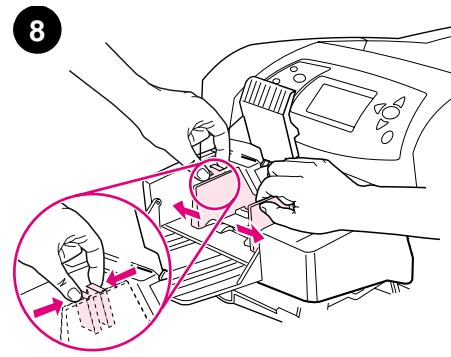
按壓左側信封導板上的釋放柄，然後將左右導板向外滑開。
