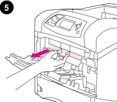
Fjern plastikdækslet til konvolutåbningen inde i printeren. **Bemærk!** Sæt dækslet på igen, når konvolutfremføreren ikke er monteret.
