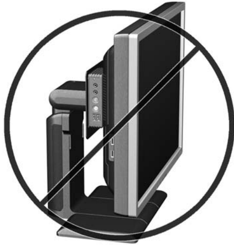
Abbildung C-8 Unsachgemäße Montageposition – HP MultiSeat-Thin Client t150 zwischen Standfuß und Monitor
