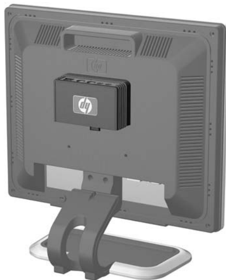
Figure C-5 Client léger HP MultiSeat t150 installé à l'arrière du moniteur
