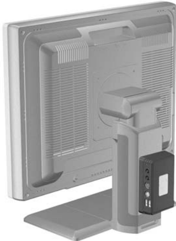
Figura C-4 HP MultiSeat Thin Client t150 montado na parte traseira da base do monitor
