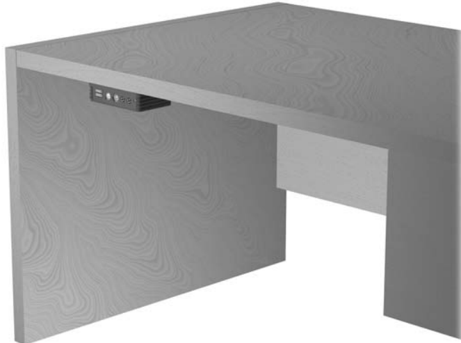
Figura C-7 HP MultiSeat Thin Client t150 montado sob uma mesa
