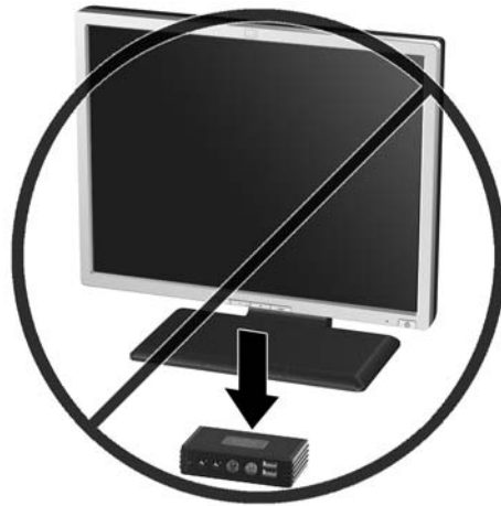
Figura D-4 Não coloque um monitor sobre o HP MultiSeat Thin Client t150
