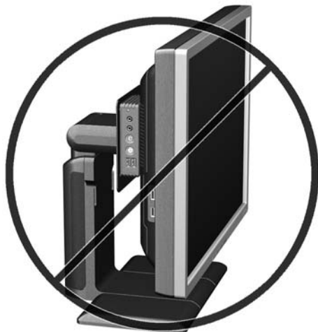
圖示 C-8 不支援的裝載位置 – HP MultiSeat 精簡型電腦 t150 裝載在機座與顯示器之間
