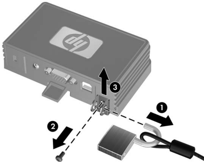
Figura C-2 Extracción del clip de seguridad
