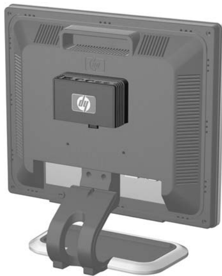
Figura C-5 HP MultiSeat Thin Client t150 montado en la parte trasera de un monitor
