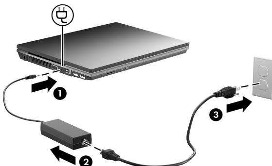
Ostavite računar priključen na spoljno napajanje dok se lampica baterije ne isključi.
