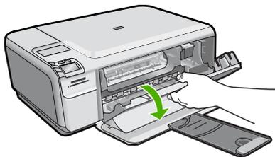
4. Espere hasta que el carro de impresión quede inactivo y en silencio. Presione ligeramente en un cartucho de impresión hacia abajo para liberarlo y a continuación tire de él para sacarlo de la ranura.
