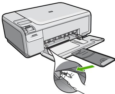
2. Inserte la pila de papel fotográfico en la parte situada más a la derecha de la bandeja de entrada con el borde corto hacia delante y la cara de impresión hacia abajo. Deslice la pila de papel fotográfico hasta que se detenga. Si el papel fotográfico que está utilizando tiene pestañas perforadas, cárguelo de modo que las pestañas estén más próximas a usted.
