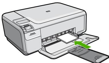
3. Mueva la guía de anchura del papel hacia dentro hasta que entre en contacto con el borde del papel. No sobrecargue la bandeja de entrada. Asegúrese de que la pila de papel encaja en la misma y de que su altura no supera la de la guía de anchura del papel.
