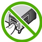
**Mögliche Ursache:** Die Schutzfolie wurde nicht vollständig von der Druckpatrone entfernt.
