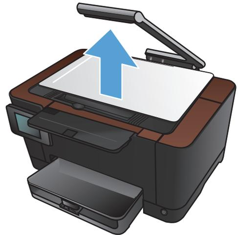
2. Coloque o documento ou objeto no estágio de captura, voltado para cima. Alinhe o canto superior esquerdo dos documentos com as arestas nas extremidades direita e posterior do estágio de captura.
