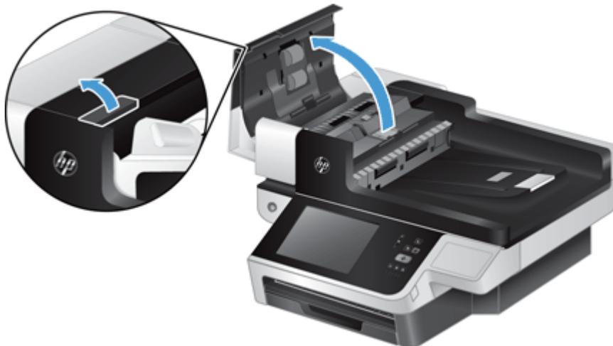
3. Ôtez tout résidu visible de fibres ou de poussière situé sur les rouleaux d'alimentation et la bande de séparation en insufflant de l'air comprimé ou au moyen d'un chiffon propre et non pelucheux imbibé d'eau chaude.
