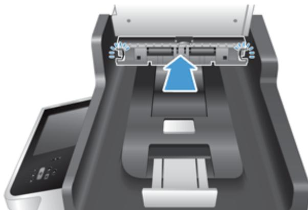
9. Abaissez le bac d'entrée du scanner pour le mettre en place, puis rebranchez le câble d'alimentation sur l'appareil.
