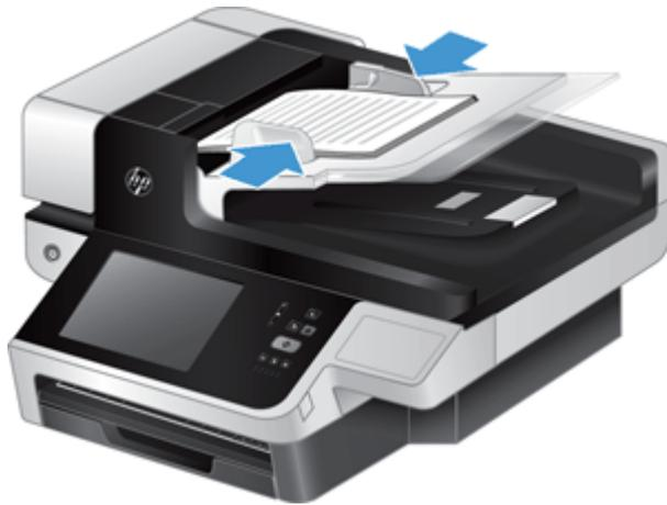
Lors de la numérisation d'originaux de format réduit, tels que des chèques, il est particulièrement important d'adapter parfaitement les guide-papier aux bords de l'original.
