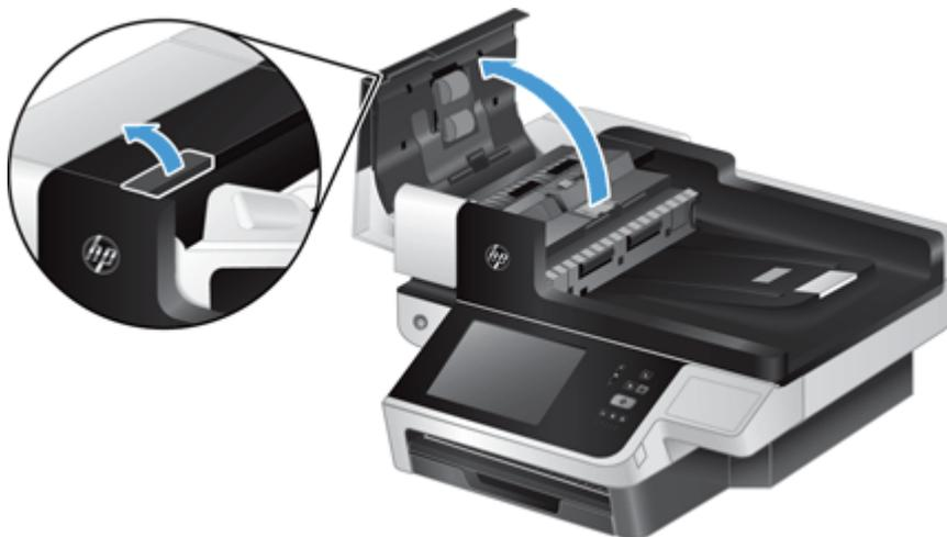
3. Premere il fermo in avanti (verso la parte posteriore dell'alimentatore automatico di documenti) per sbloccare il cuscinetto di separazione.
