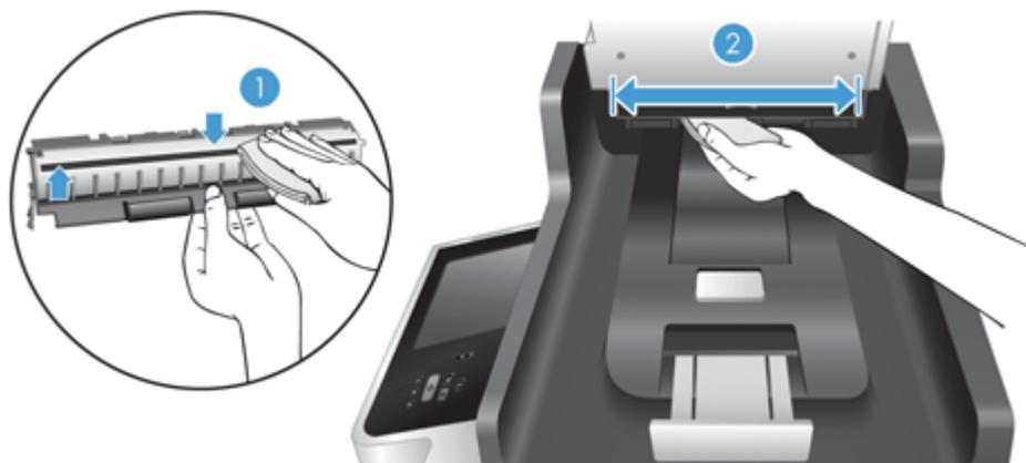
8. Asciugare la parte posteriore dell'unità fronte/retro ADF con un panno asciutto, morbido e senza pelucchi, quindi far scorrere il componente nell'alloggiamento finché non scatta in posizione.
