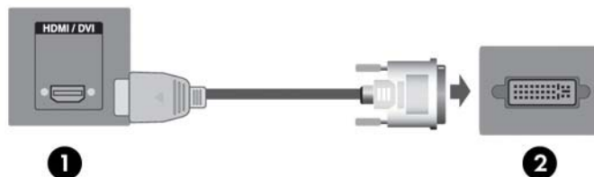
Figura 3-14 Conexão do Cabo de Sinal HDMI para DVI
