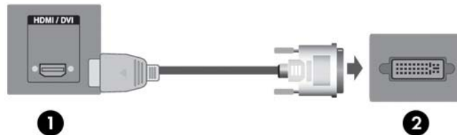
Figura 3-14 Conexión del cable de señal HDMI a DVI
