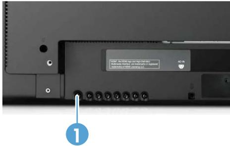
**Abbildung 3-25** HP LD4710 – Netzschalter
