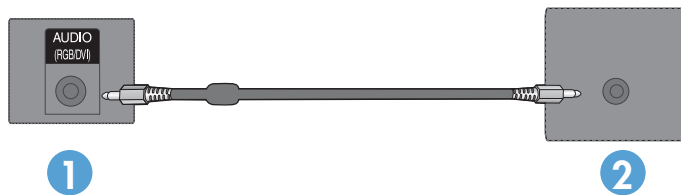
Figura 3-21 Collegamento del cavo audio.
