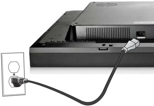
Figura 3-23 HP LD4710 - Collegamento del cavo di alimentazione
