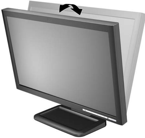
Figura 3-7 Inclinación del Monitor
