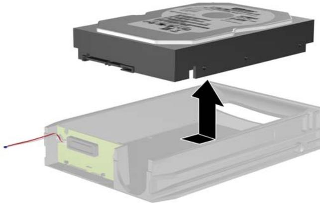
6. Platzieren Sie die neue Festplatte in der Halterung, und schieben Sie die Festplatte wieder hinein, so dass sie im SATA-Anschluss auf der Platine der Halterung sitzt. Stellen Sie sicher, dass der Anschluss an der Festplatte vollständig in den Anschluss auf der Platine der Halterung hineingedrückt ist.
