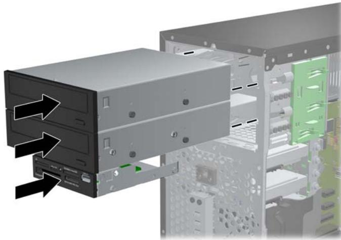
9. Schließen Sie die Strom- und Datenkabel an das Laufwerk an (siehe Abbildungen).
