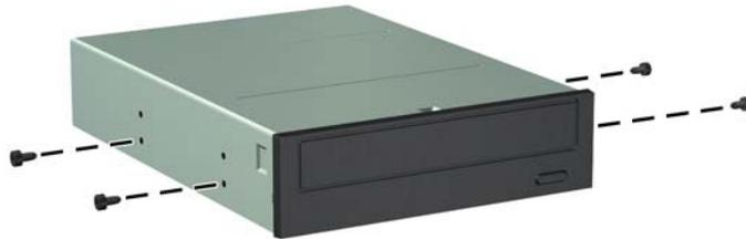
**Abbildung 4-23** Installieren von Führungsschrauben am optischen Laufwerk (2 von 2)
