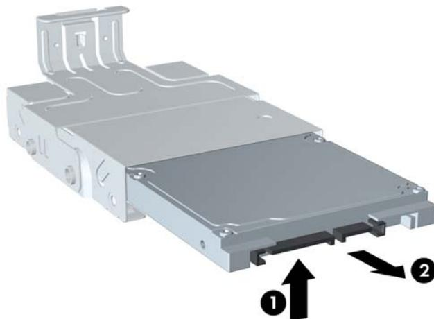
12. Um zu verhindern, dass die Platine an der Unterseite der Festplatte die Verriegelungen unten an der Halterung berührt, heben Sie die Festplatte an, bis deren Oberseite oben an der Halterung anliegt (1), und schieben Sie dann die neue Festplatte in die Halterung (2).
