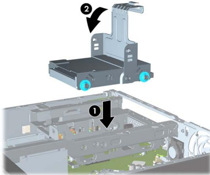
15. Setzen Sie das optische Laufwerk wieder ein, und schließen Sie das Kabel an der Rückseite des optischen Laufwerks an.
