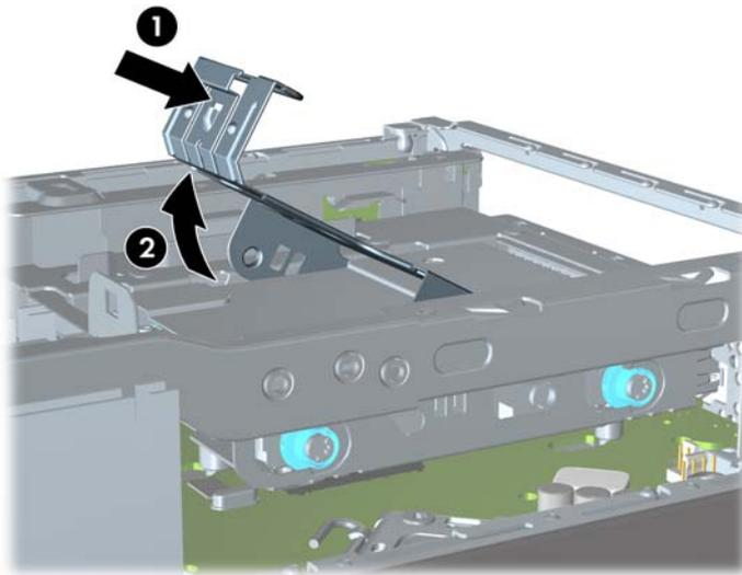
9. Heben Sie die Festplattenhalterung gerade nach oben aus dem Gehäuse heraus.
