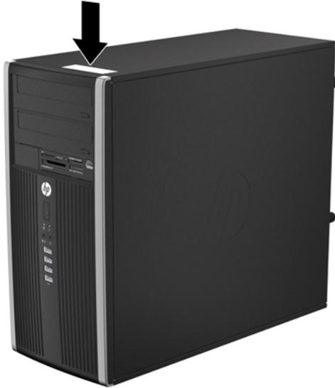
**Abbildung 1-16** Position von Seriennummer und Produkt-ID des Small Form Factor
