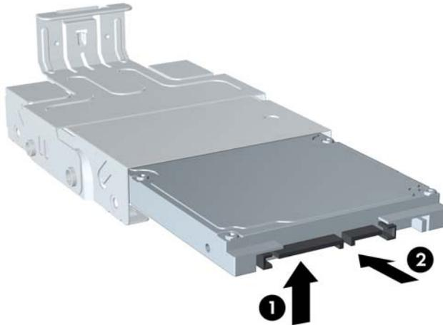
13. Setzen Sie die Festplatte unten in die Halterung ein (1), und schrauben Sie die vier Führungsschrauben in die Seiten der Halterung, um das Laufwerk in der Halterung zu sichern (2).
