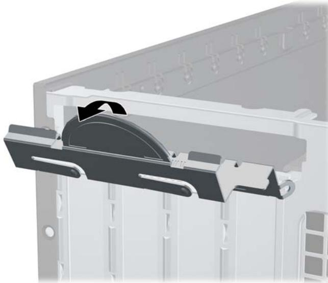
9. Bevor Sie eine Erweiterungskarte installieren, entfernen Sie die Steckplatzabdeckung oder die vorhandene Erweiterungskarte am Computergehäuse.
