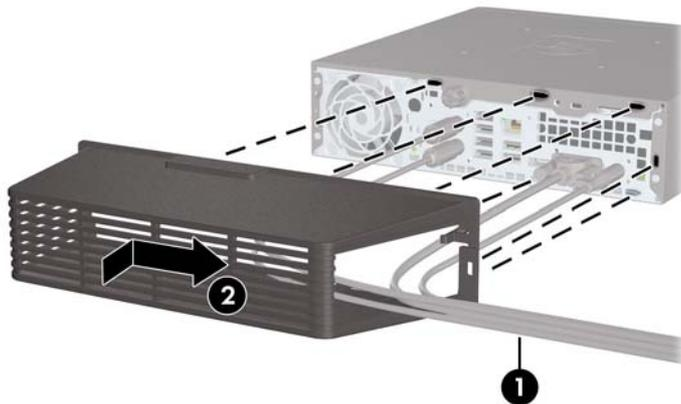
**HINWEIS:** Aus Sicherheitsgründen können Sie eine optionale Kabel-Diebstahlsicherung am Gehäuse anbringen, mit der die Anschlussabdeckung verriegelt und der Computer gesichert wird. Siehe [„Anbringen eines Sicherheitsschlusses“ auf Seite 162](#).
