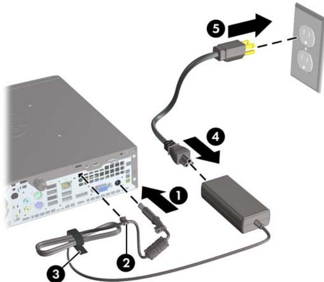
△ **ACHTUNG:** Wenn das Netzkabel mit dem Befestigungsclip nicht richtig gesichert wird, besteht die Gefahr, dass es sich löst und Daten verloren gehen.
