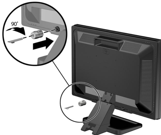
3. Stecken Sie das Sicherheitskabel durch das Loch des Kensington-Schlosses auf der Rückseite des Monitors.
