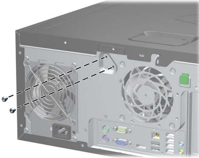
**Abbildung C-2** Entfernen der Schrauben der Smart Cover-Sperre des Minitower
