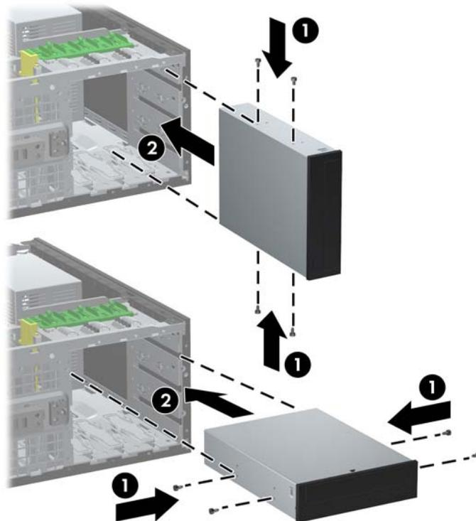
8. Setzen Sie das Laufwerk in den gewünschten Laufwerksschacht ein, indem Sie es ganz nach vorne in den Laufwerksschacht einschieben, bis es einrastet (2). Die Laufwerksverriegelung sichert das Laufwerk automatisch im Schacht.
