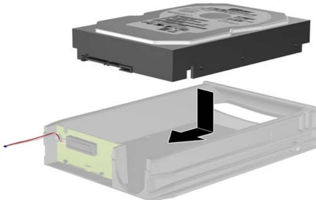
7. Bringen Sie die vier Schrauben wieder am unteren Teil der Halterung an, um das Laufwerk sicher zu befestigen.
