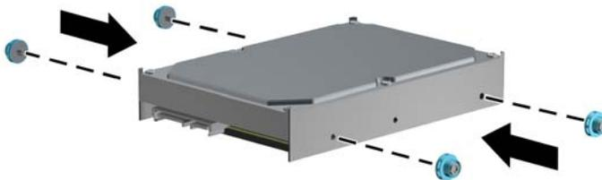
12. Richten Sie die Führungsschrauben an den Steckplätzen am Laufwerksgehäuse aus, drücken Sie das Laufwerk nach unten in den Schacht hinein, und schieben Sie es so weit wie möglich nach hinten, bis es einrastet.
