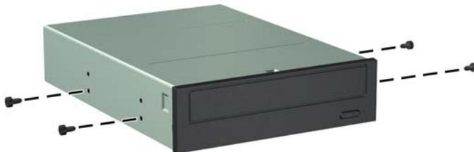
8. Schieben Sie das Laufwerk in den Laufwerksschacht hinein, und achten Sie auf die korrekte Ausrichtung der Führungsschrauben an den Führungen, bis das Laufwerk richtig sitzt.
