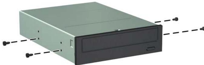
9. Setzen Sie das Laufwerk mit den Führungsschrauben in die J-förmigen Schlitz im Laufwerksschacht ein. Schieben Sie das Laufwerk dann nach vorne, bis es einrastet.
