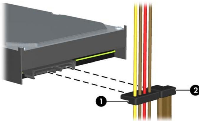
7. Lösen Sie das Laufwerk, indem Sie den Freigaberiegel an der Laufwerksverriegelung anheben (1) und anschließend das Laufwerk vorsichtig aus dem Schacht herausziehen (2).
