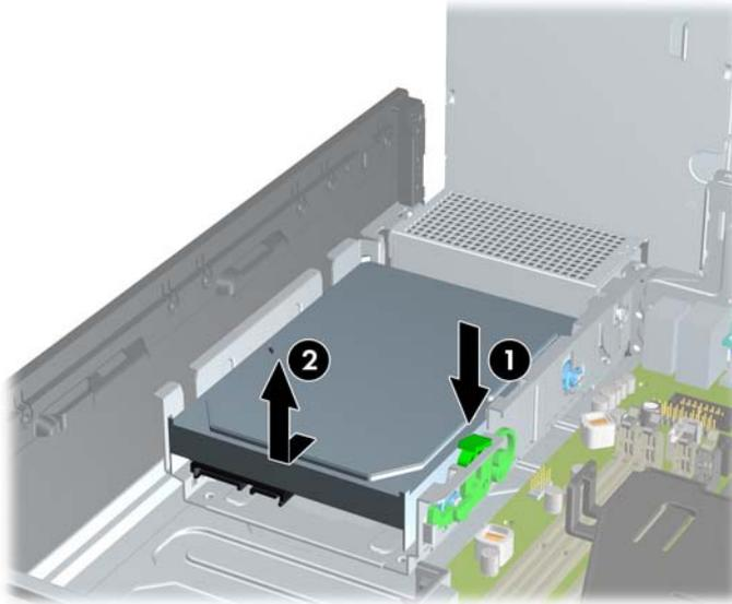
11. Wenn Sie ein Festplattenlaufwerk einbauen möchten, müssen Sie die silberfarbenen und blauen Führungsschrauben zur isolierten Montage aus der alten Festplatte entfernen und in die neue Festplatte eindrehen.
