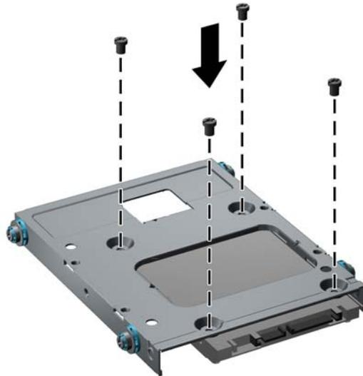
7. Schieben Sie das Laufwerk in den Laufwerksschacht, und richten Sie die Führungsschrauben an den Bohrungen aus, bis das Laufwerk einrastet. Der untere Schacht ist für das primäre Festplattenlaufwerk vorgesehen. Der obere Schacht ist für eine optionale sekundäre Festplatte vorgesehen.
