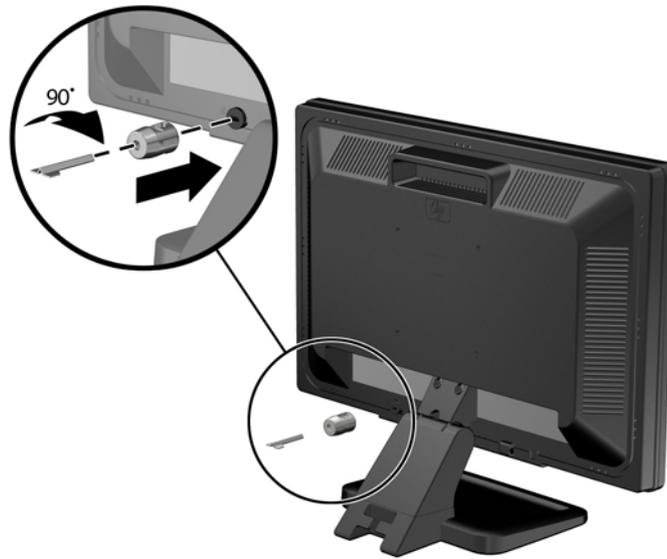
3. Stecken Sie das Sicherheitskabel durch das Loch des Kensington-Schlusses auf der Rückseite des Monitors.
