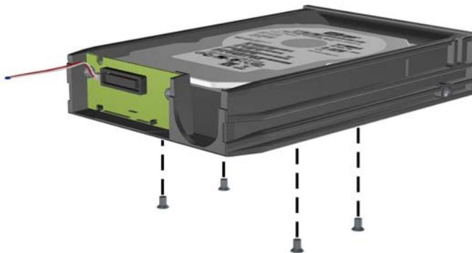
5. Schieben Sie die Festplatte wieder hinein, um sie von der Halterung zu lösen, und heben Sie sie an und aus der Halterung heraus.
