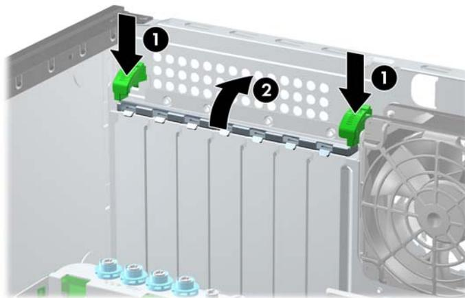
8. Bringen Sie eine Steckplatzabdeckung an, oder setzen Sie eine weitere Erweiterungskarte ein, um den freien Steckplatz zu schützen.
