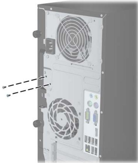
**Abbildung C-3** Entfernen der Schrauben der Smart Cover-Sperre des Small Form Factor
