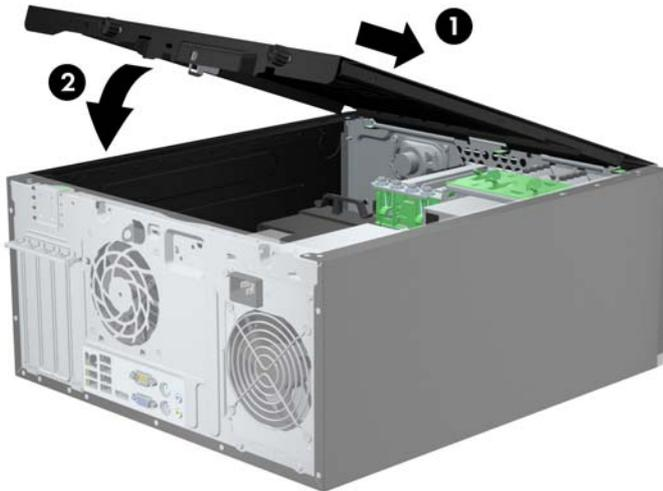
2. Stellen Sie sicher, dass die Abdeckung vollständig geschlossen ist (1), und ziehen Sie die beiden Rändelschrauben fest, mit denen die Zugangsabdeckung am Gehäuse befestigt wird (2).
