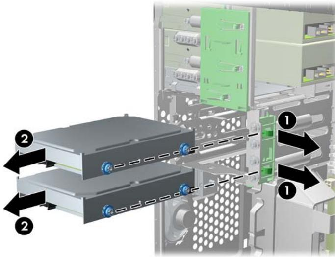
8. Entfernen Sie die vier Führungsschrauben (zwei auf jeder Seite) des bisherigen Laufwerks. Sie benötigen diese Schrauben für das neue Laufwerk.
