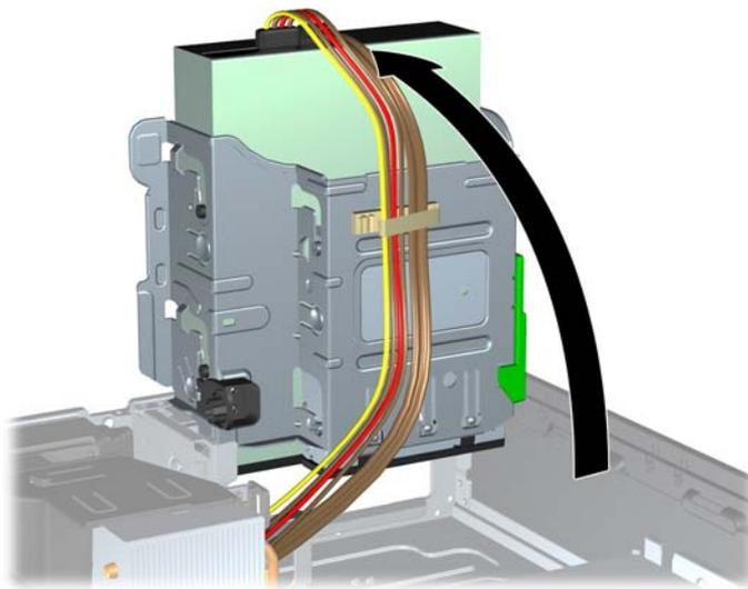
8. Wenn Sie ein optisches Laufwerk ausbauen, ziehen Sie das Stromkabel (1) und das Datenkabel (2) auf der Rückseite des optischen Laufwerks ab.
