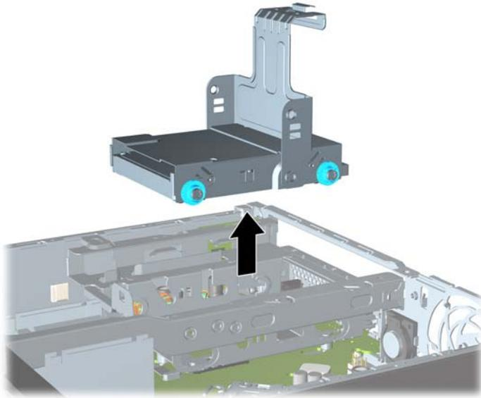
10. Entfernen Sie die vier Führungsschrauben von den Seiten der Festplattenhalterung.
