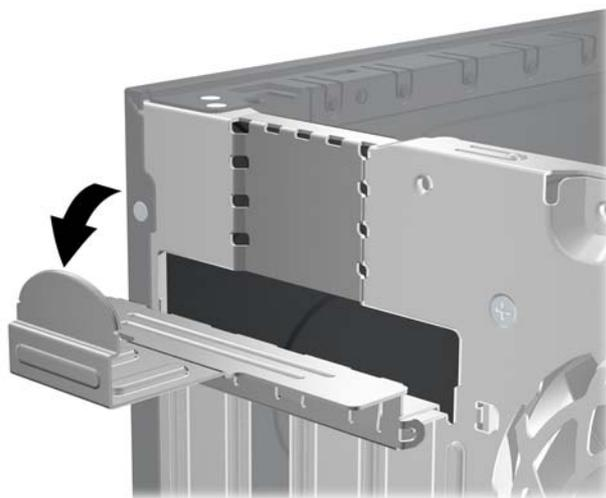
8. Entfernen Sie vor dem Einsetzen einer Erweiterungskarte die Steckplatzabdeckung bzw. eine bereits vorhandene Erweiterungskarte.
