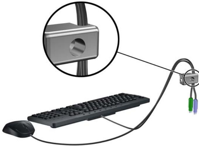
6. Schrauben Sie das Schloss mit der beigelegten Schraube in das Rändelschraubenloch.
