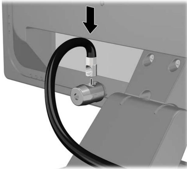
4. Verwenden Sie die Halterung, die im Lieferumfang des Kits enthalten ist, um andere Peripheriegeräte zu sichern. Legen Sie hierzu das Gerätekabel über die Mitte der Halterung (1) und stecken Sie das Sicherheitskabel durch eines der beiden Löcher in der Halterung (2). Verwenden Sie das Loch in der Halterung, mit dem das Peripheriegerät am besten gesichert wird.
