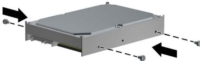
7. Setzen Sie das Laufwerk wie folgt in den Schacht ein:
