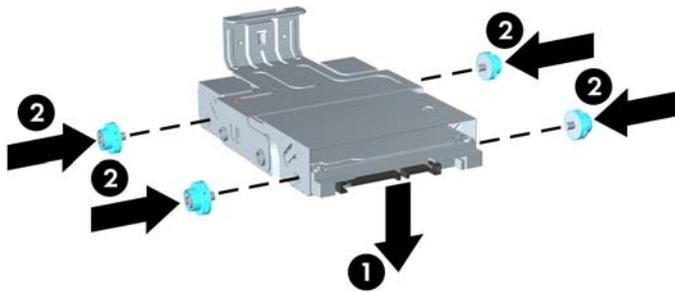
14. Wenn Sie die Halterung des Festplattenlaufwerks wieder in das Gehäuse einsetzen möchten, richten Sie die Führungsschrauben an den Öffnungen am Laufwerksschacht aus, senken Sie die Halterung nach unten in den Laufwerksschacht ab (1), und drücken Sie den Griff an der Halterung ganz nach unten (2), so dass das Laufwerk richtig eingesetzt ist und einrastet.
