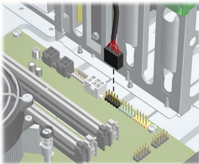
10. Bei der Installation eines neuen Laufwerks schließen Sie das andere Ende des Datenkabels an den entsprechenden Anschluss auf der Systemplatine an.
