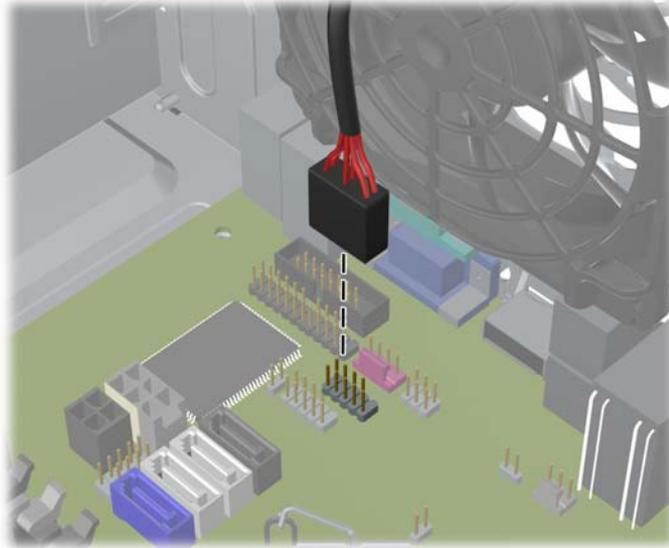
10. Bei der Installation eines neuen Laufwerks verbinden Sie das andere Ende des Datenkabels mit dem entsprechenden Anschluss auf der Systemplatine.
