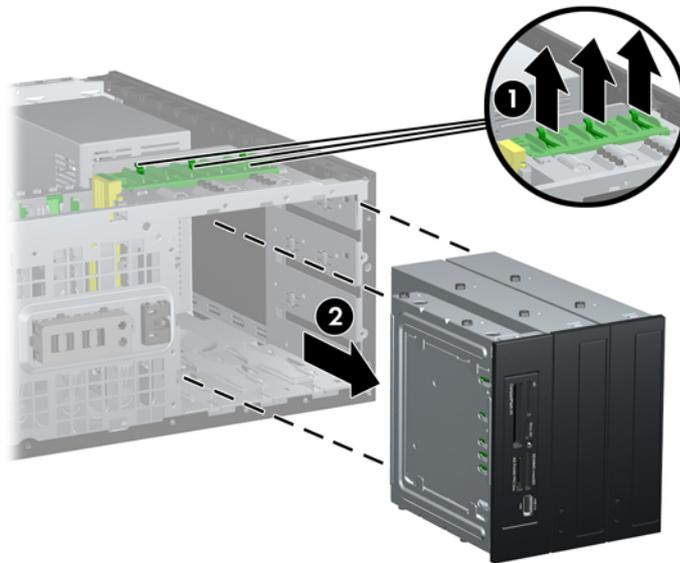
9. Schieben Sie das Laufwerk vorsichtig in den obersten freien Schacht, bis es einrastet. Wenn das Laufwerk ordnungsgemäß eingesetzt wird, wird es von der Laufwerksverriegelung arretiert. Wiederholen Sie diesen Schritt für jedes Laufwerk.
