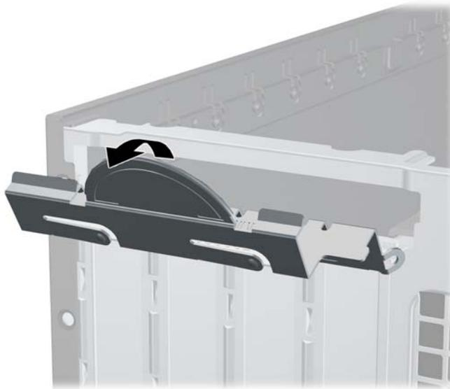
9. Prima di installare una scheda di espansione, rimuovere il coperchietto dello slot di espansione o la scheda di espansione esistente.
