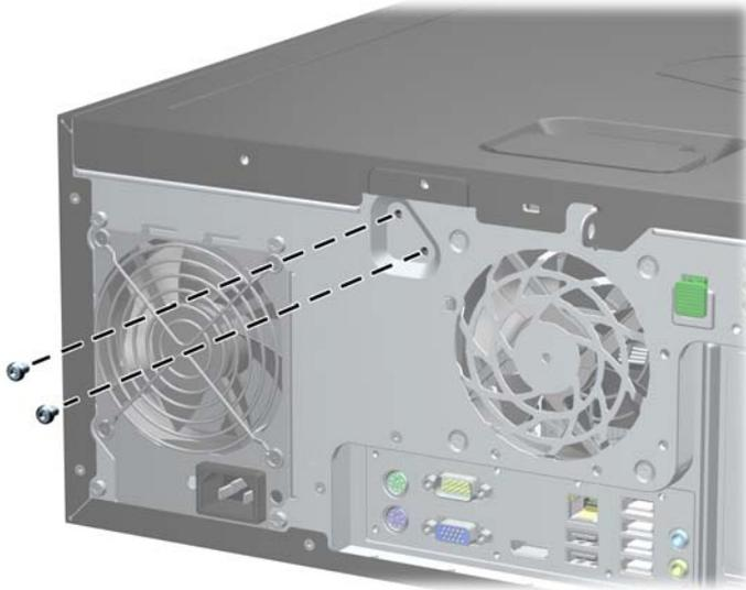
**Figura C-2** Rimozione delle viti di blocco del coperchio dalla microtower
