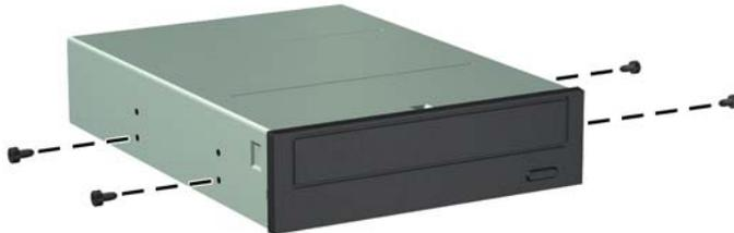
**Figura 4-23** Installazione delle viti guida nell'unità ottica (2 di 2)
