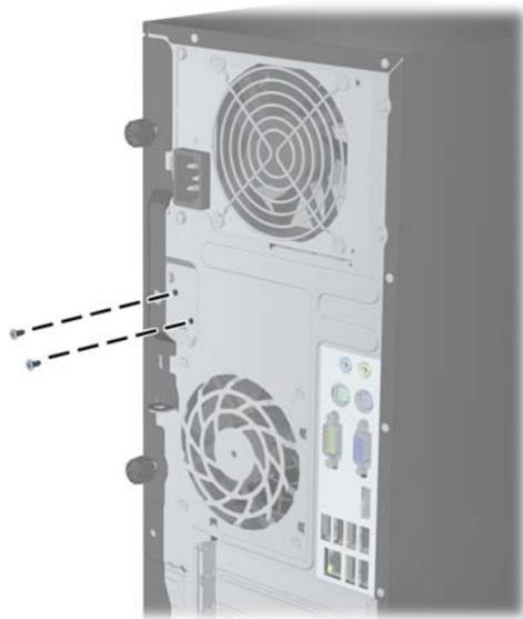
**Figura C-3** Rimozione delle viti di blocco del coperchio dall'SFF
