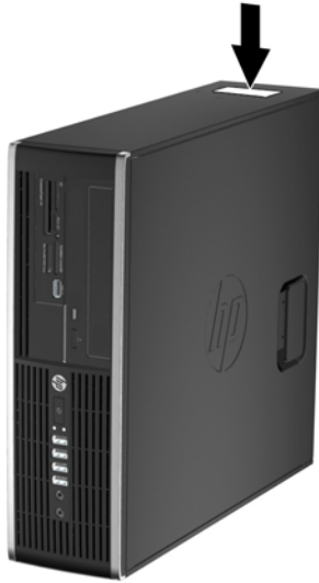
Şekil 1-16 Small Form Factor Seri Numarasının ve Ürün Kimliğinin Konumu
