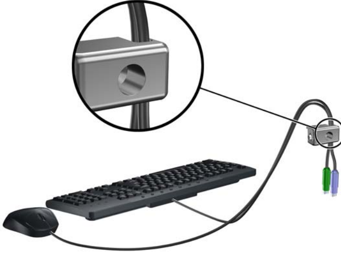
Şekil 3-39 Klavye ve Fare Kablolarını Kilitten Geçirme
