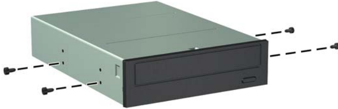
Şekil 4-23 Optik Disk Sürücüsüne Kılavuz Vidaları Takma (2 / 2)
