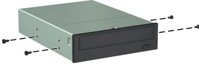
Şekil 4-23 Optik Disk Sürücüsüne Kılavuz Vidaları Takma (2 / 2)
