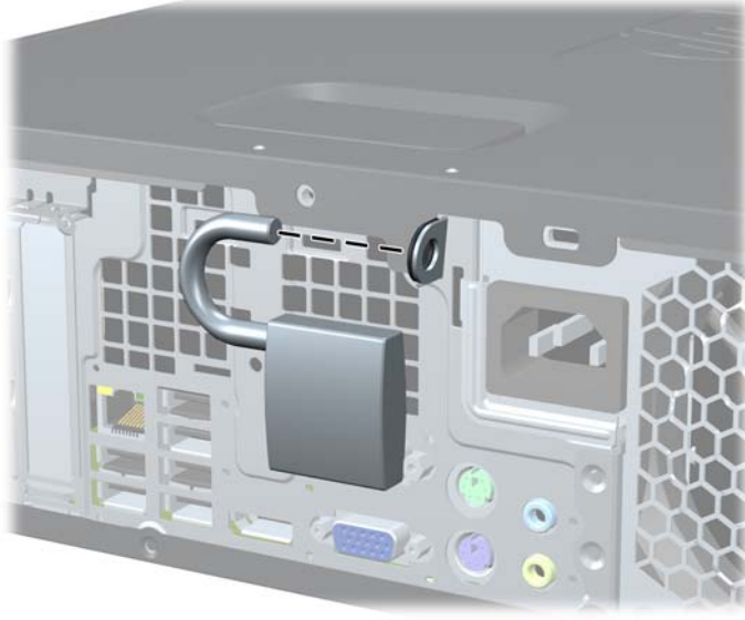
Şekil 4-42 Asma Kilidin Takılması
