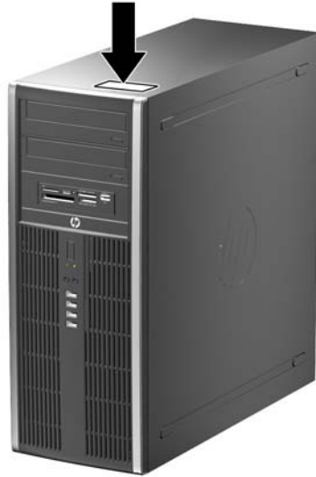
Şekil 1-14 Dönüştürülebilir Küçük Kasa Seri Numarasının ve Ürün Kimliğinin Konumu
