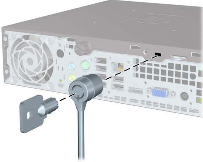
Şekil 5-25 Bağlantı Noktası Kapağı Takılı Olarak Kablo Takma
