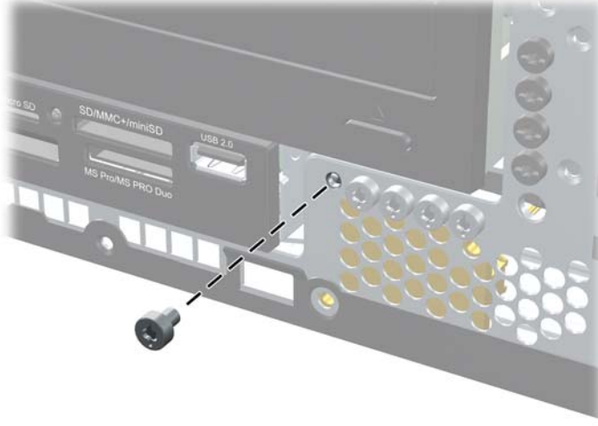
Şekil 4-51 Ön Çerçeve Sabitleme Vidasının Alınması
