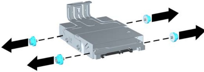
Şekil 5-17 Kılavuz Vidalarını Çıkarma
