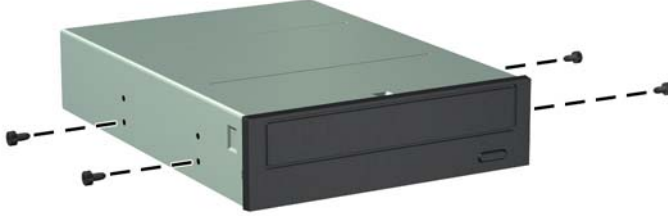
Şekil 3-21 Kılavuz Vidaları Takma (Optik Sürücü Gösterilmiştir)
