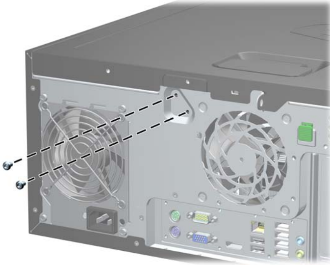
Şekil C-2 Akıllı Kapak Kilidi Vidalarının Küçük Kasadan Çıkarılması
