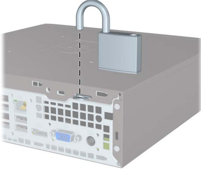
Şekil 5-26 Asma Kilidin Takılması
