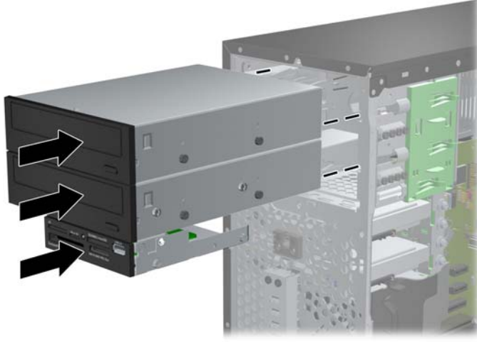
Şekil 3-22 Sürücülerini Kaydırarak Sürücü Kafesine Yerleştirme
