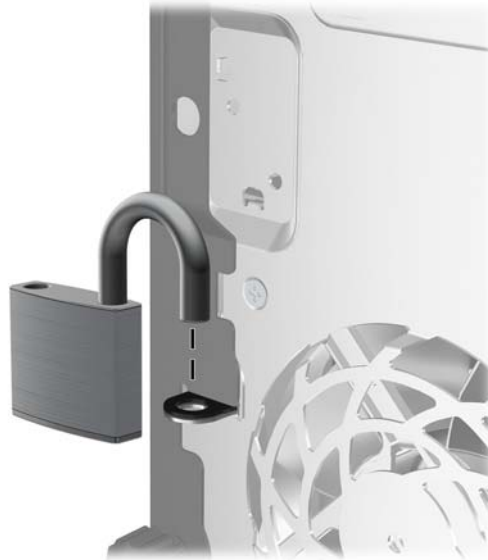
Şekil 3-34 Asma Kilidin Takılması
