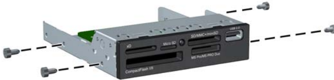
Şekil 4-30 Kılavuz Vidaları Takma (Ortam Kartı Okuyucu Gösterilmiştir)
