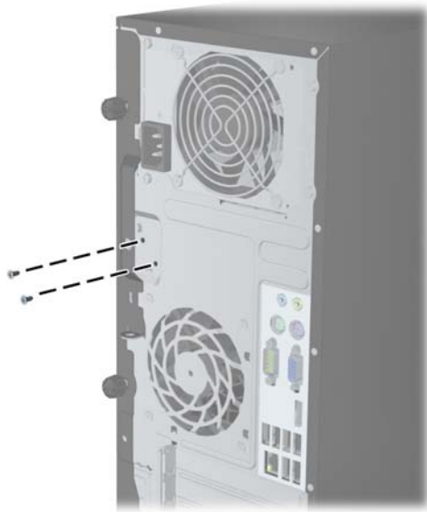
Şekil C-2 Akıllı Kapak Kilidi Vidalarının Küçük Kasadan Çıkarılması
