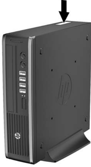
Şekil 1-17 Ultra İnce Masaüstü (USDT) Seri Numarasının ve Ürün Kimliğinin Konumu
