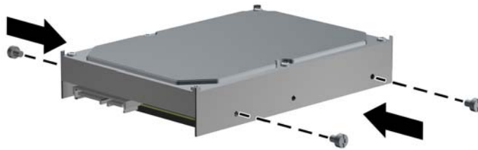
Εικόνα 2-29 Τοποθέτηση τυπικών βιδών-οδηγών
