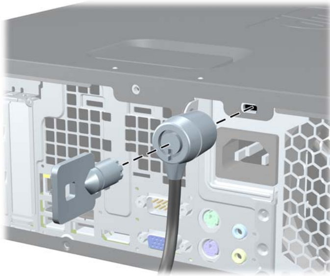
Εικόνα 4-41 Εγκατάσταση κλειδαριάς καλωδίου
