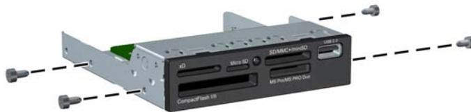
4. Posicione os parafusos-guia na unidade nos slots J do compartimento. Em seguida, deslize a unidade na direção frontal do computador até que ela trave no local.
