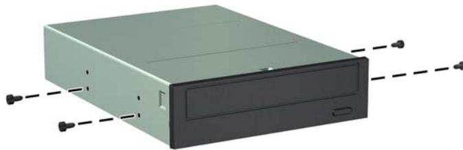
**Figura 4-23** Instalação dos parafusos-guia na unidade óptica (2 de 2)
