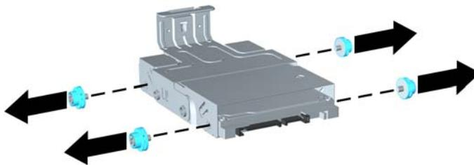
11. Levante a unidade de disco rígido da parte superior do portador (1) e deslize a unidade para fora do portador (2).
