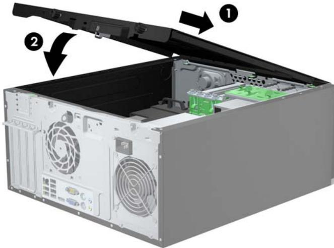
2. Assegure-se de que o painel esteja completamente fechado (1) e aperte os dois parafusos que fixam o painel de acesso no chassi (2).
