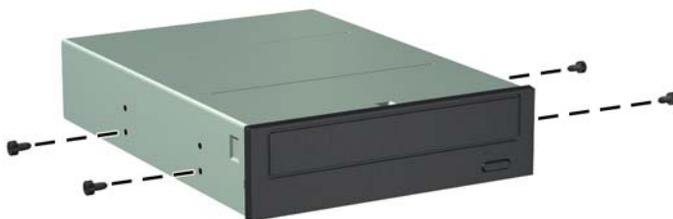
8. Deslize a unidade para dentro do compartimento, assegurando-se de alinhar os parafusos-guia com os slots, até a unidade encaixar-se em seu lugar.
