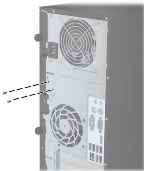
**Figura C-3** Remoção dos parafusos de trava da Smart Cover no Formato Compacto
