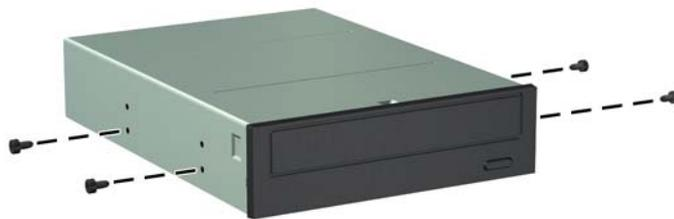
9. Posicione os parafusos-guia na unidade nos slots J do compartimento. Em seguida, deslize a unidade na direção frontal do computador até que ela trave no local.
