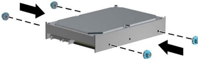
12. Alinhe os parafusos-guia com os slots no chassi do compartimento de unidade, pressione a unidade de disco rígido no compartimento, em seguida deslize a unidade para trás até travá-la no lugar.
