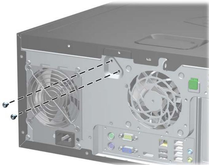
**Figura C-2** Remoção dos parafusos de trava da Smart Cover na Microtorre
