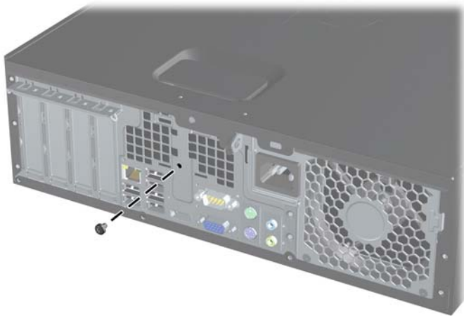
Фигура С-3 Отстраняване на винтове за фиксатор на капак от модел с малки размери
