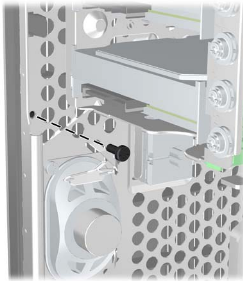
Фигура 3-44 Поставяне на защитния винт на лицевия панел
