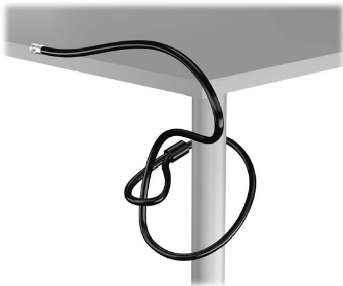
Фигура 2-41 Закрепване на кабела за неподвижен предмет
