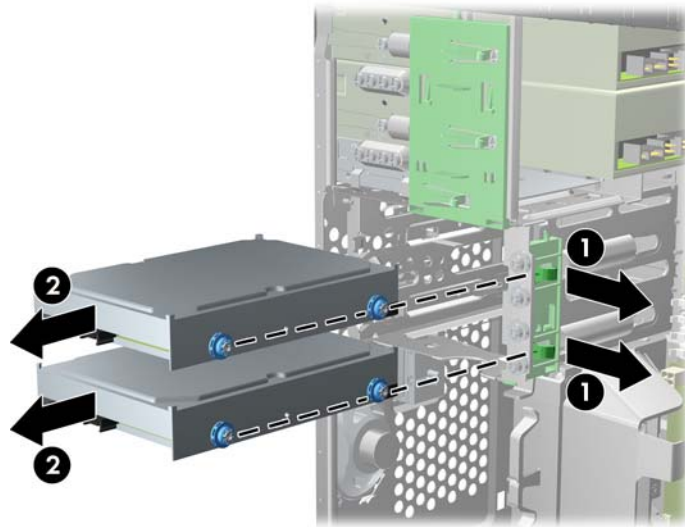
Фигура 3-26 Изваждане на твърд диск
