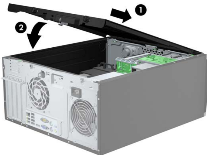
Фигура 3-2 Поставяне на панела за достъп до компютъра
