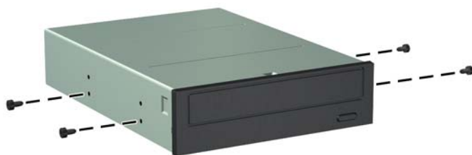
Фигура 4-23 Поставяне на водещи винтове в оптичното устройство (2 от 2)
