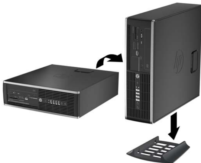
Фигура 4-6 Промяна от Desktop (хоризонтална) на Tower (вертикална) конфигурация
