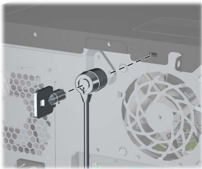
Фигура 2-39 Поставяне на кабелна ключалка
