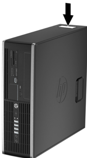
Фигура 1-16 Местоположение на серийния номер и продуктивния идентификатор при модел с малки размери
