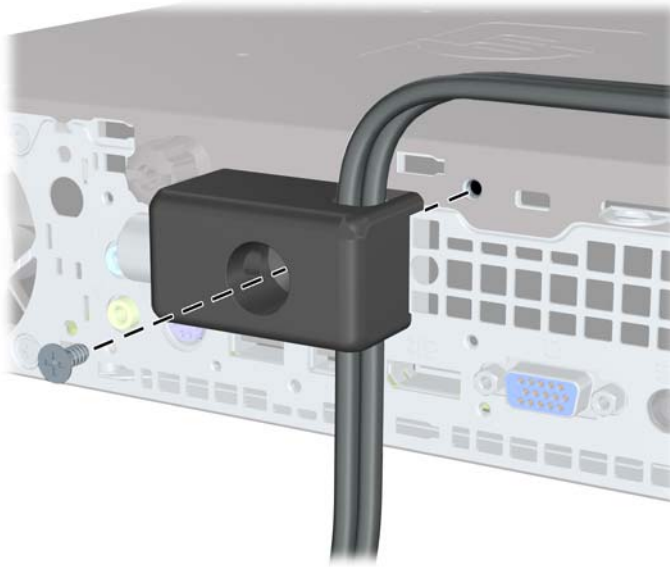
Фигура 5-32 Закрепване на фиксатора към шасито
