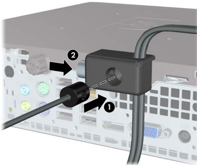
Figura 5-33 Activarea dispozitivului de blocare
