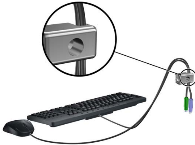
ภาพ 3-39 การสอดสายเคเบิลของแป้นพิมพ์และเมาส์
