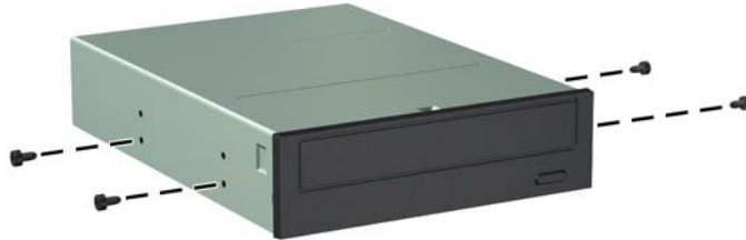
ภาพ 4-23 การติดตั้งสกรูตัวนำในไดรฟ์ออปติคัล (2 จาก 2)
