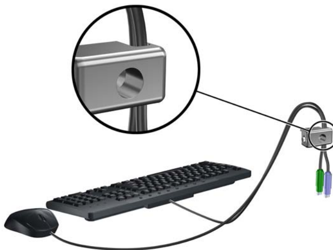
ภาพ 4-47 การสอดสายเคเบิลของแป้นพิมพ์และเมาส์
