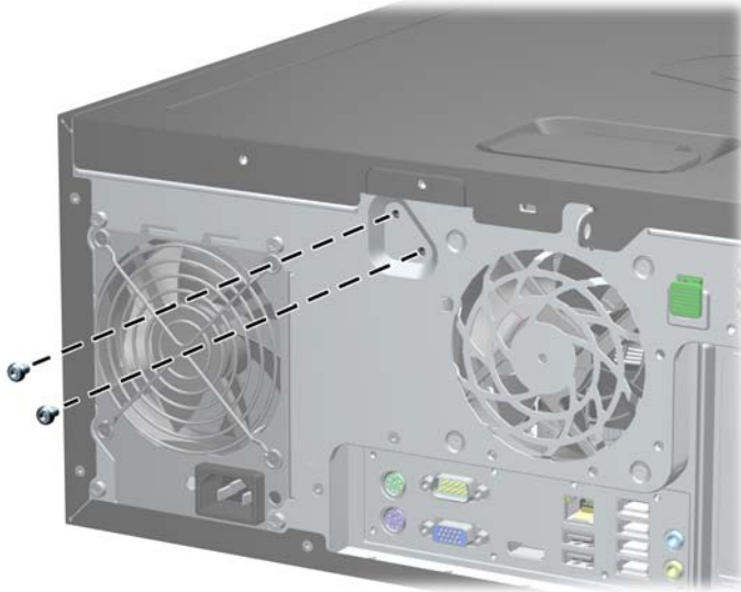
ภาพ C-2 การถอดสลักรักษา Smart Cover Lock ออกจาก Minitower
