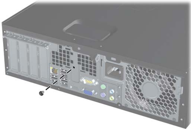
ภาพ C-3 การถอดสกรูล็อค Smart Cover Lock ออกจาก Small Form Factor
