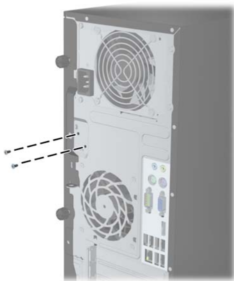
ภาพ C-2 การถอดสลักรักษา Smart Cover Lock ออกจาก Minitower
