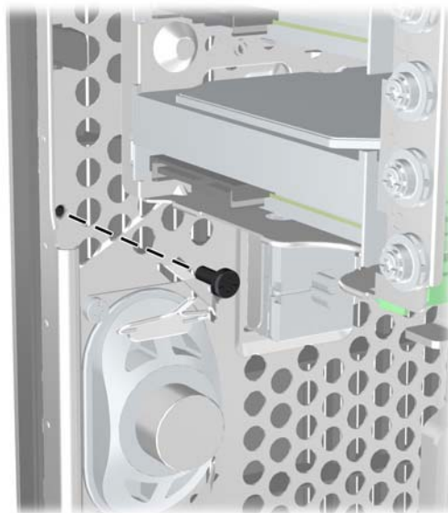
ภาพ 3-44 การติดตั้งสกรูรักษาความปลอดภัยสำหรับแผงด้านหน้า
