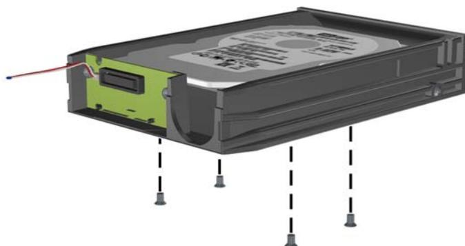
5. ハードディスク ドライブを後方にスライドさせてキャリアから抜き、次に上に持ち上げてキャリアから取り出します。
