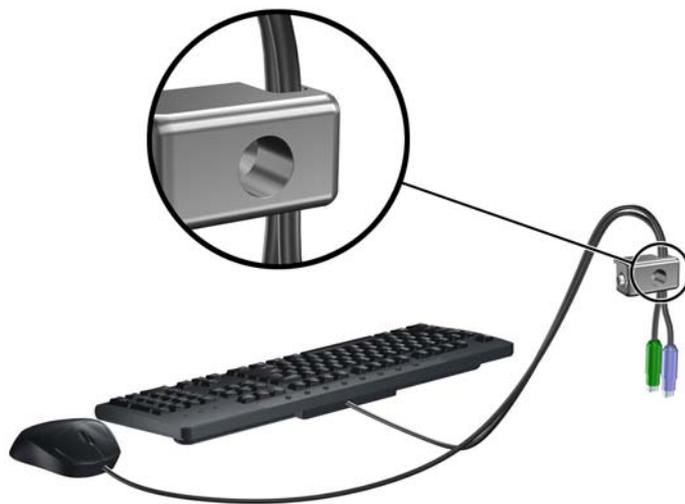
6. 付属のネジを使用して、ロックをシャーシのネジ穴に固定します。
