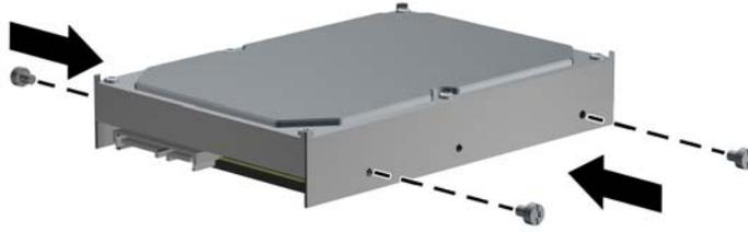
7. 以下のように、ハードディスク ドライブをベイに挿入します。
