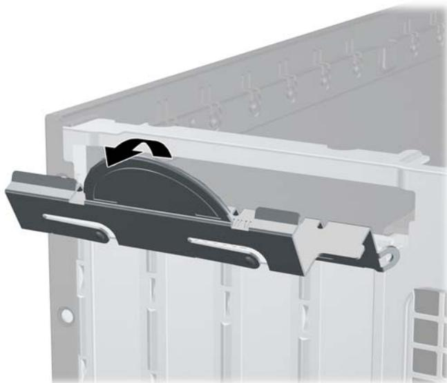
9. 新しい拡張カードを取り付ける前に、拡張スロット カバーまたは装着されている拡張カードを取り外します。
