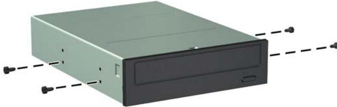
9. ドライブのガイド用ネジの位置をドライブ ベイ内の J 字型のスロットの位置に合わせます。次に、正しい位置にロックされるまで、ドライブをコンピューターの前面の方向にスライドさせます。
