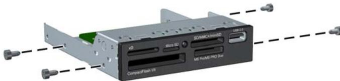
4. ドライブのガイド用ネジの位置をドライブ ベイ内の J 字型のスロットの位置に合わせます。次に、正しい位置にロックされるまで、ドライブをコンピューターの前面の方向にスライドさせます。
