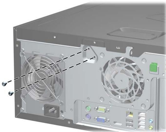
図 C-2 マイクロタワー型からのスマート カバー ロックの不正防止ネジの取り外し
