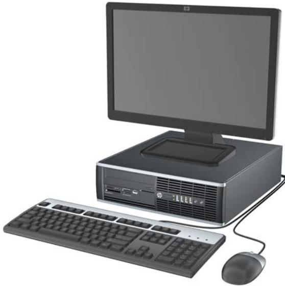
注記： 省スペース型コンピューターは、縦置きで使用することもできます。詳しくは、このガイドの100 ページの「横置きから縦置きへの変更」を参照してください。
