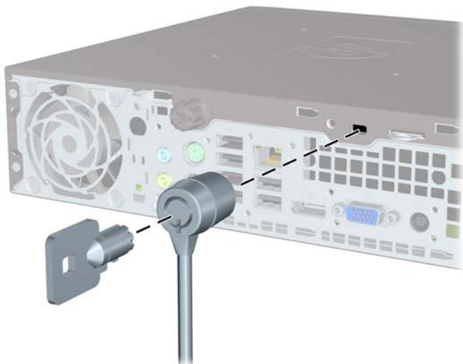
図 5-25 コネクタ カバーを使用する場合のロック ケーブルの取り付け
