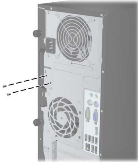
図 C-3 省スペース型からのスマート カバー ロックの不正防止ネジの取り外し
