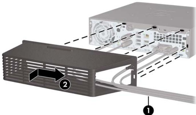
注記： セキュリティ上の理由から、シャーシにオプションのロック ケーブルを取り付けて、コネクタ カバーをロックし、コンピューターを固定させられます。157 ページの「[セキュリティ ロックの取り付け](#)」を参照してください。
