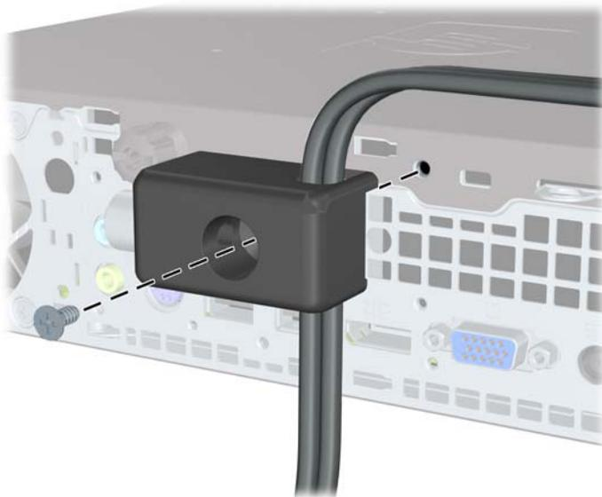
7. セキュリティ ケーブルの端の栓を差し込み (1)、ボタンを押し込んで (2) ロックを固定します。ロックの固定を外すには、付属の鍵を使用します。
