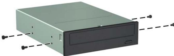
8. ガイド用ネジがガイド用のスロットとかみ合っていることを確認し、ドライブが所定の位置に収まるまでドライブをドライブ ベイにスライドさせて挿入します。
