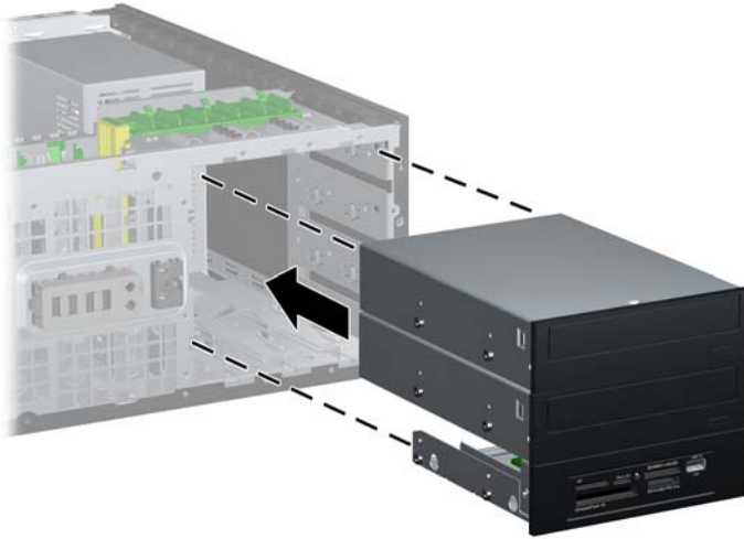
图 2-34 在台式机配置中安装驱动器
