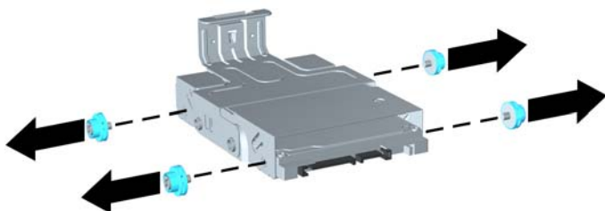
图 5-17 拧下导向螺钉
