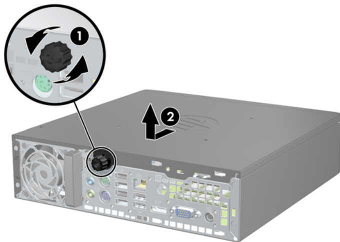
图 5-2 卸下计算机检修面板
