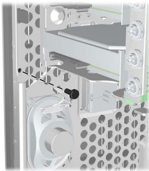
图 3-44 安装前面板安全保护螺钉
