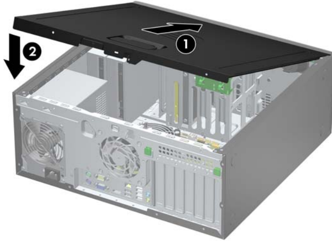
图 2-2 重新装上计算机检修面板
