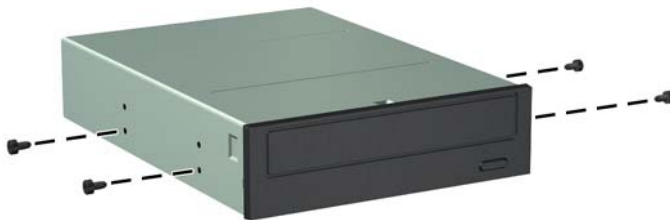
图 4-23 在光驱中安装导向螺钉 (2 / 2)
