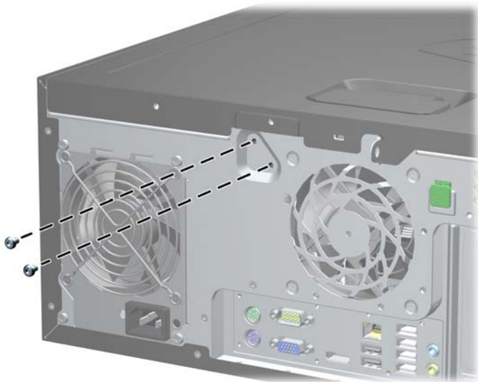
图 C-2 卸下小型立式机型的智能锁扣螺钉
