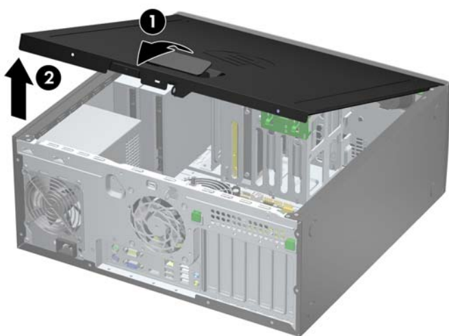
图 2-1 卸下计算机检修面板
