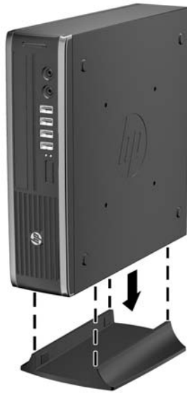
图 5-7 将计算机放到底座上
