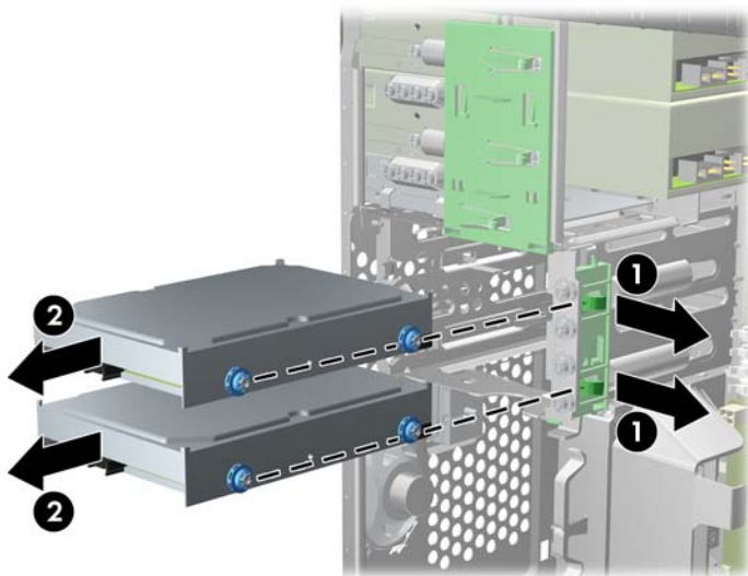
图 3-26 卸下硬盘驱动器
