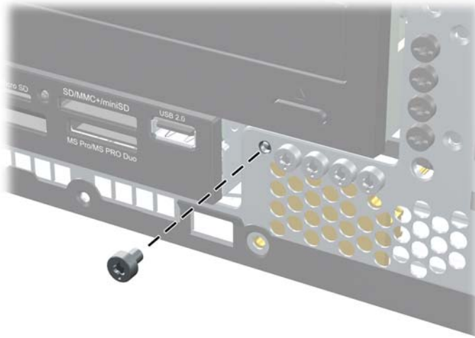
图 4-51 获取前面板安全保护螺钉
