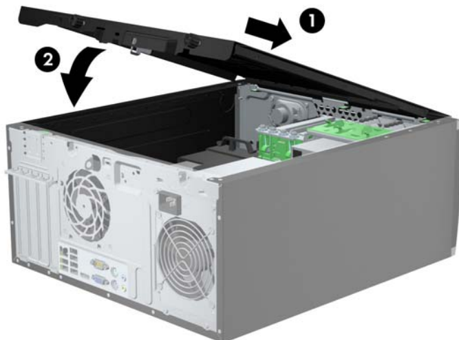
图 3-2 重新装上计算机检修面板
