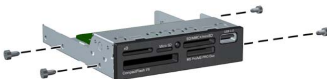
图 4-30 安装导向螺钉（所示为介质卡读卡器）
