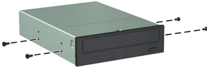
图 4-23 在光驱中安装导向螺钉 (2 / 2)
