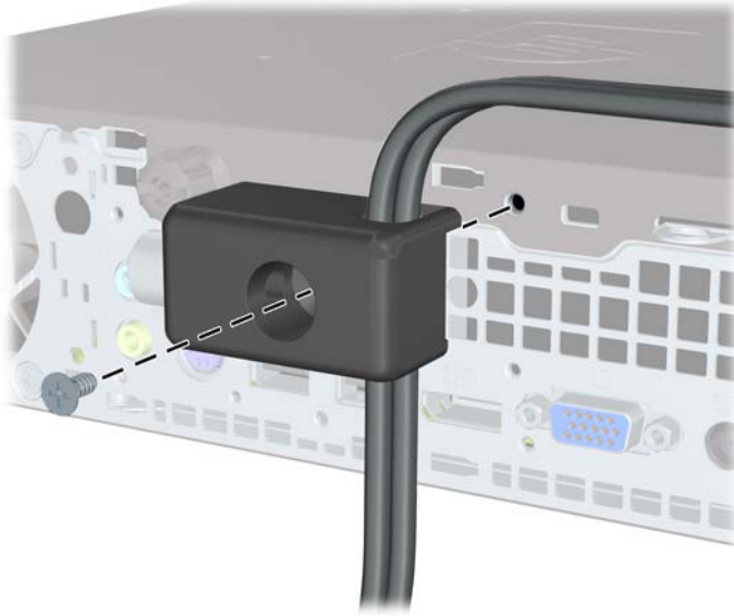
图 5-32 将钳锁固定到机箱上
