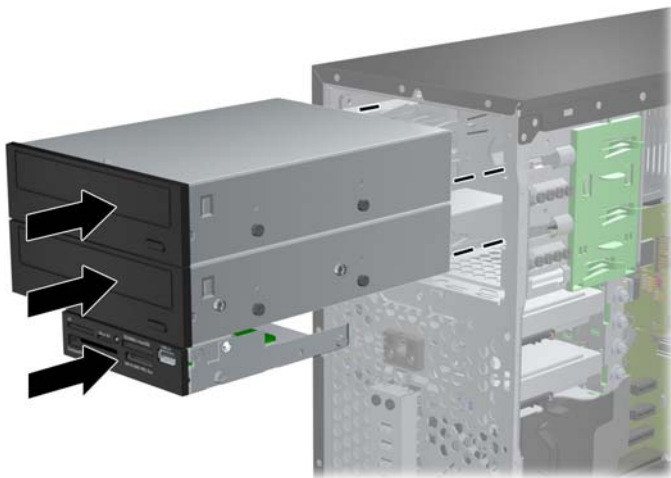
图 3-22 将驱动器滑入驱动器框架
