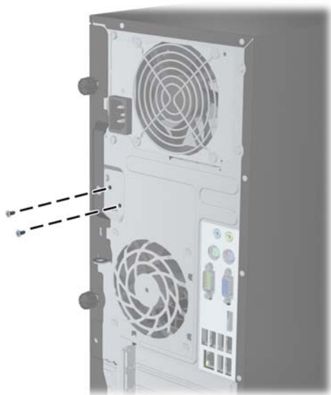
图 C-2 卸下小型立式机型的智能锁扣螺钉
