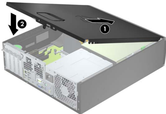
图 4-2 重新装上计算机检修面板
