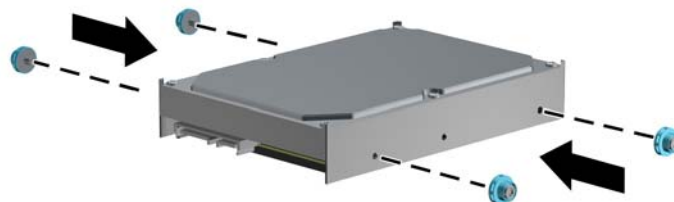
图 4-38 安装硬盘驱动器导向螺钉
