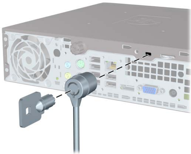
圖示 5-25 已安裝連接埠外蓋時安裝纜線
