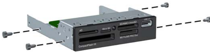
圖示 4-30 安裝導引螺絲（所示為媒體讀卡機）
