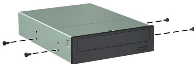
圖示 3-21 鎖入導引螺絲（所示為光碟機）
