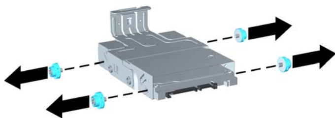
圖示 5-17 拆下導引螺絲
