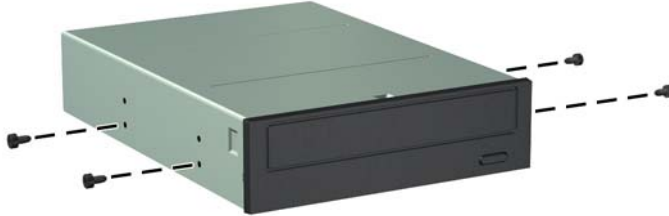
圖示 4-23 將導引螺絲鎖入光碟機 (2 之 2)
