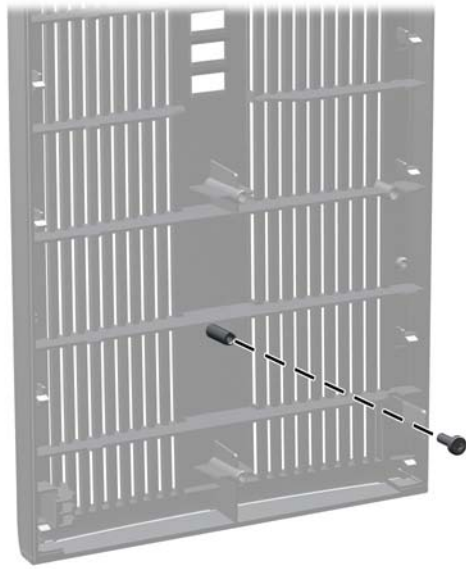
圖示 2-49 取回前面板安全固定螺絲
