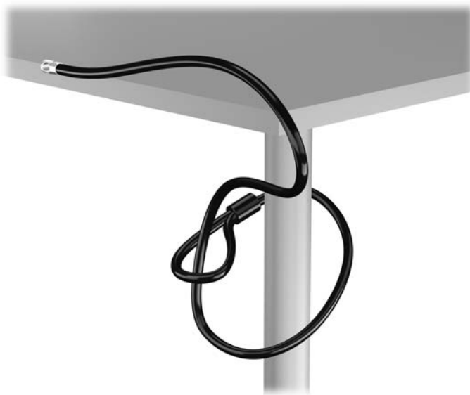
圖示 5-27 將纜線固定在固定物體上
