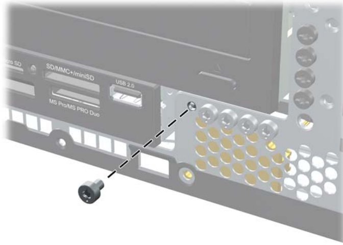
圖示 4-51 取回前面板安全固定螺絲
