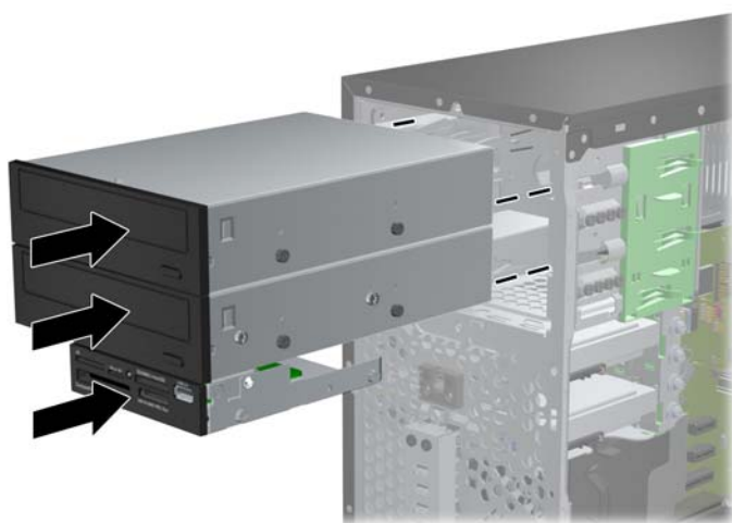
圖示 3-22 將磁碟機推入磁碟機座
