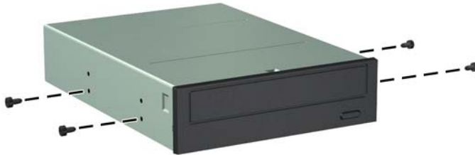
圖示 4-23 將導引螺絲鎖入光碟機 (2 之 2)
