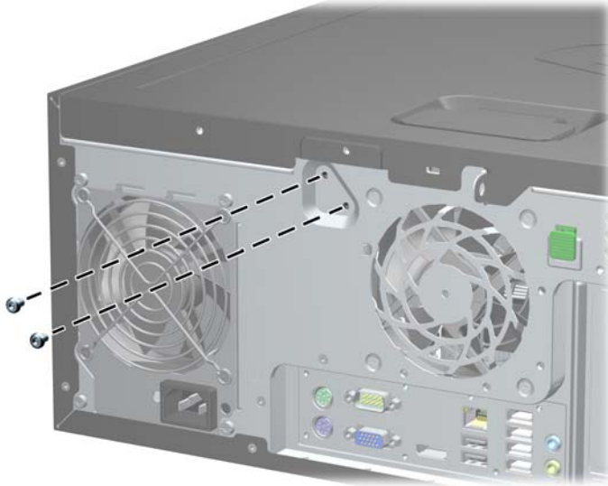
그림 C-2 마이크로타워의 스마트 덮개 잠금 나사 분리
