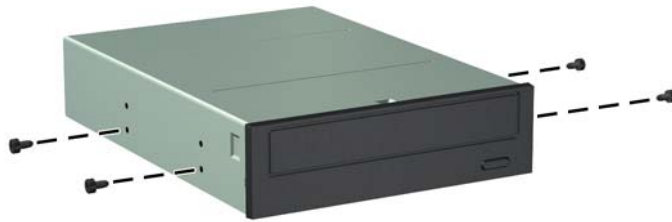
그림 4-23 광 드라이브에 유도 나사 설치 (2 / 2)
