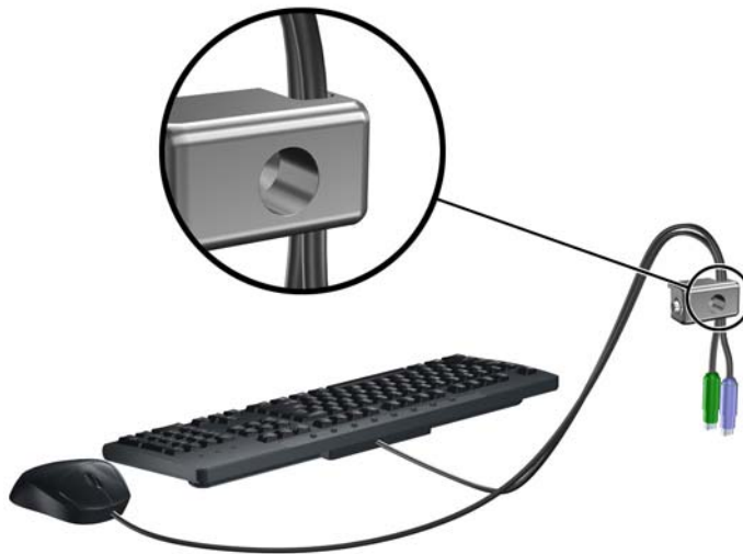
그림 4-47 키보드 및 마우스 케이블 모아 넣기
