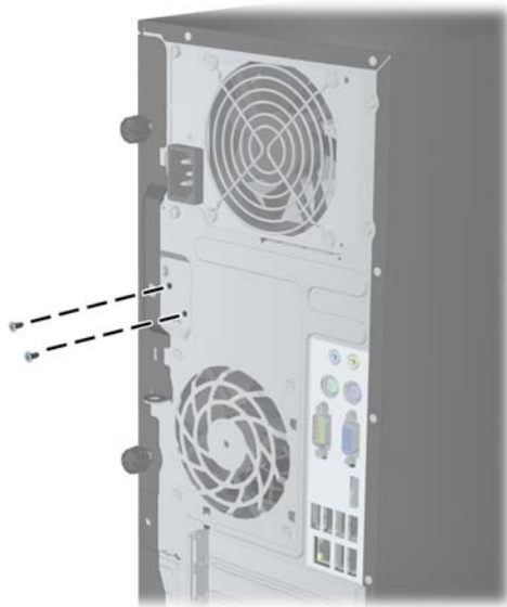
그림 C-2 마이크로타워의 스마트 덮개 잠금 나사 분리
