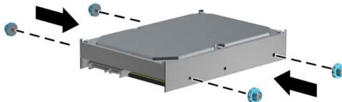
그림 2-25 3.5 인치 하드 드라이브에 절연 장착 유도 나사 설치
