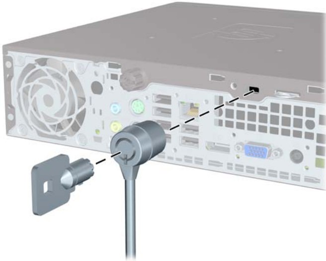
그림 5-25 포트 덮개가 있는 경우 케이블 설치
