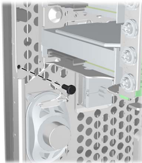
그림 3-44 전면 베젤 고정 나사 설치
