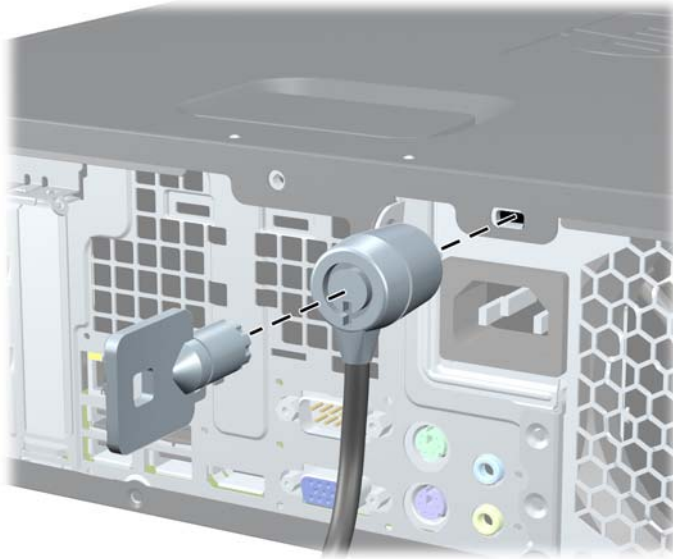
그림 4-41 케이블 잠금 장치 설치
