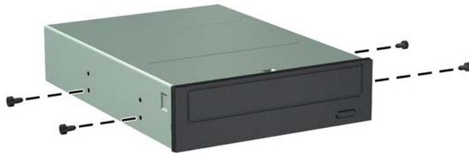
그림 4-23 광 드라이브에 유도 나사 설치 (2 / 2)
