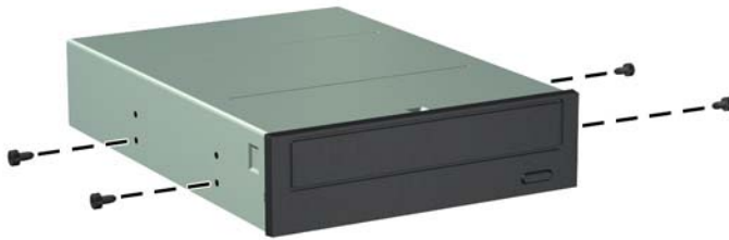
그림 3-21 유도 나사 설치(그림은 광 드라이브)
