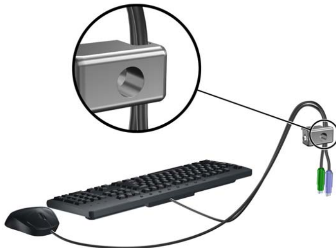
Slika 3-39 Povezivanje kabela tipkovnice i miša
