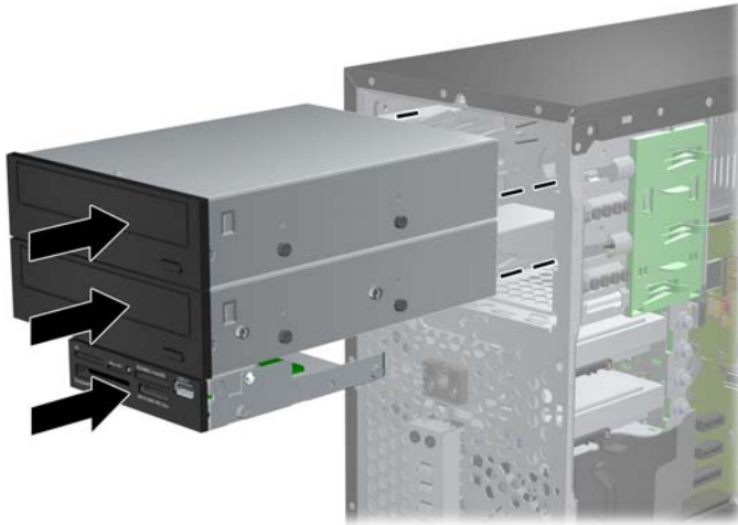
Slika 3-22 Uvlačenje pogona u ležište pogona
