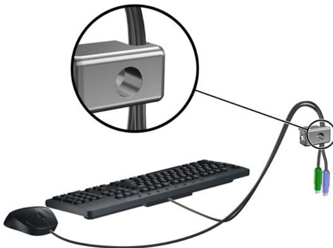
Slika 5-31 Provođenje kabela tipkovnice i miša
