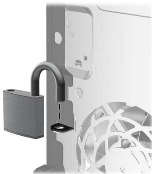
Slika 3-34 Ugrađivanje sigurnosnog lokota
