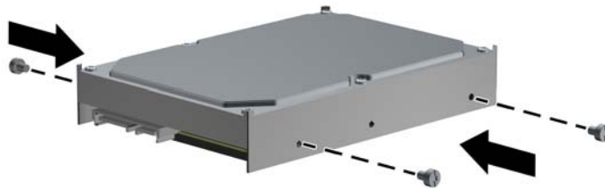
Slika 2-29 Ugradnja standardnih vijaka
