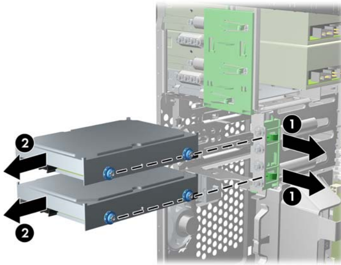
Slika 3-26 Uklanjanje tvrdog diska
