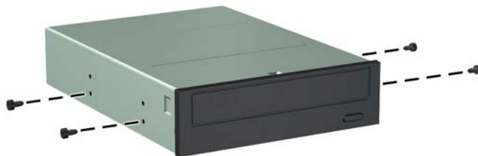
Slika 4-23 Ugradnja vijaka za vođenje u optički pogon (2 od 2)
