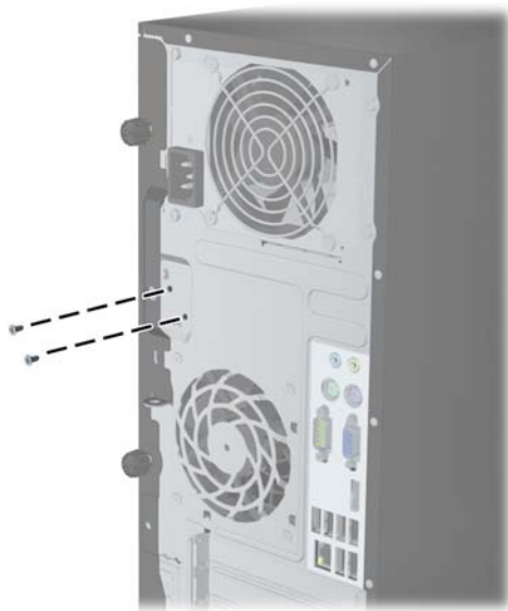
Slika C-2 Uklanjanje Smart Cover Lock vijaka s računala Microtower
