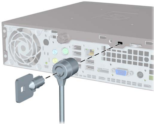
Slika 5-25 Ugradnja kabela s ugrađenim poklopcem priključnice
