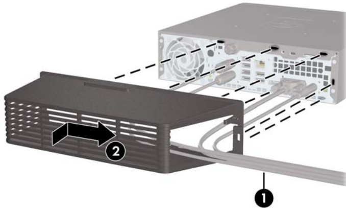
Slika 5-22 Ugradnja poklopca priključnice
