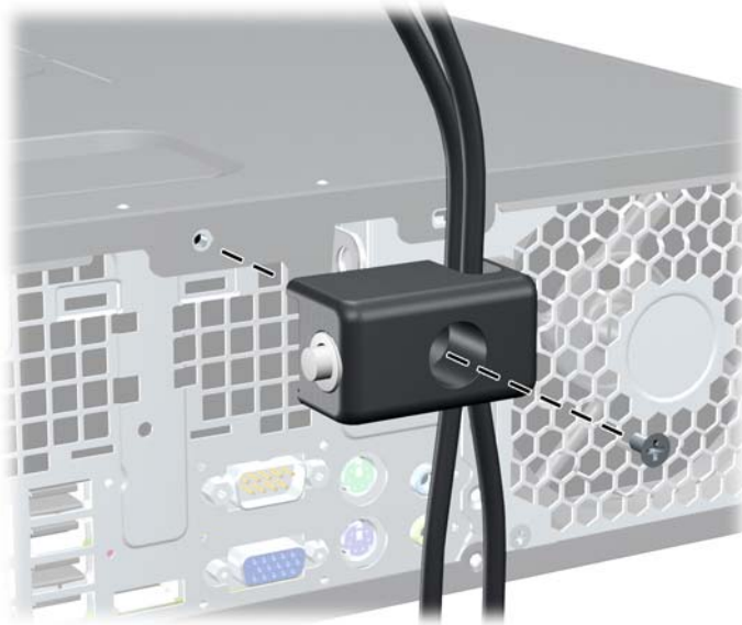
Slika 4-48 Pričvršćivanje brave na kućište
