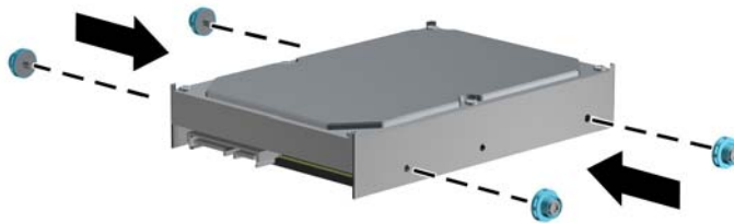
Slika 4-38 Ugradnja vijaka za tvrdi disk
