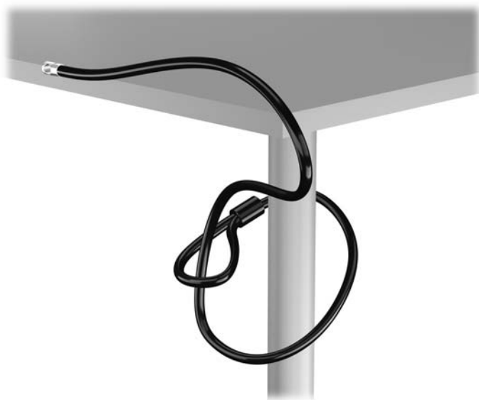
Рисунок 3-35 Закріплення кабелю на нерухомому об'єкті
