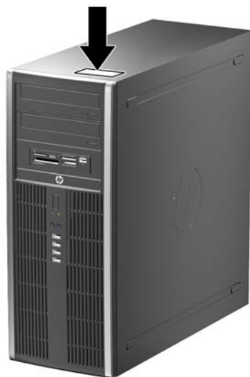
Рисунок 1-14 Розміщення серійного номера й ідентифікаційного коду виробу на Convertible Minitower
