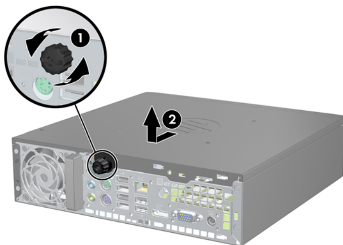
Рисунок 5-2 Видалення знімної панелі комп'ютера
