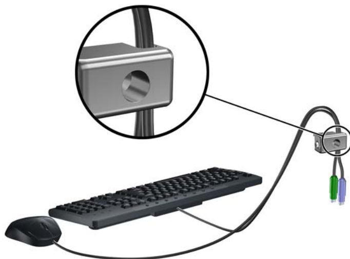
Рисунок 3-39 Просування кабелів клавіатури і миші
