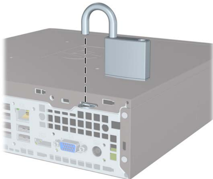
Рисунок 5-26 Встановлення висячого замка
