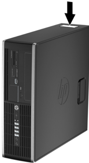
Рисунок 1-16 Розміщення серійного номера й ідентифікаційного коду виробу на “малому форм-факторі”
