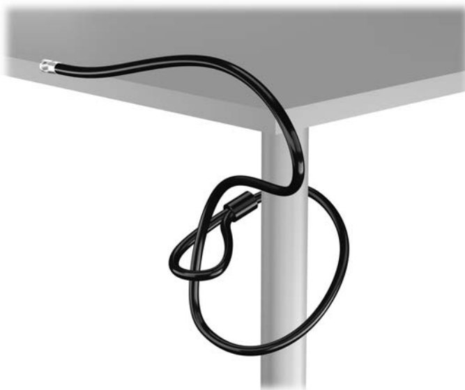
Рисунок 4-43 Закріплення троса навколо нерухомого об'єкта
