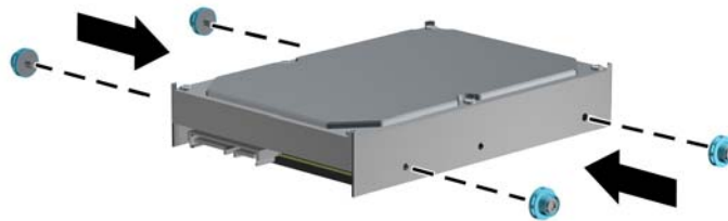
Рисунок 4-38 Встановлення направляючих гвинтів жорсткого диска
