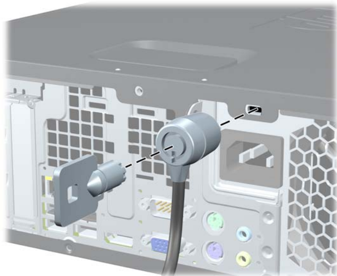
Рисунок 4-41 Встановлення фіксатора кабелю
