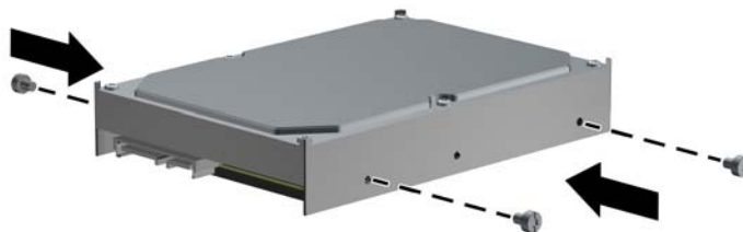
Рисунок 2-29 Встановлення стандартних направляючих гвинтів
