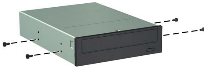
Рисунок 4-23 Встановлення напрямних гвинтів оптичного привода (2 з 2)
