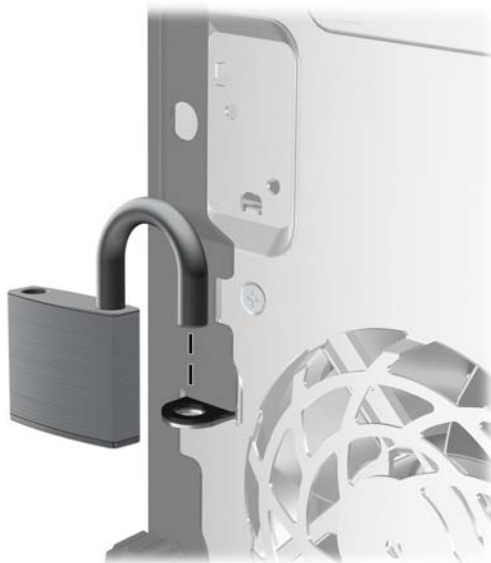
Attēls 3-34 Slēdzenes uzstādīšana
