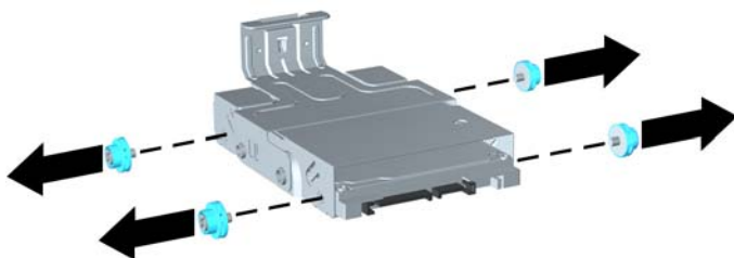
Slika 5-17 Uklanjanje zavrtnja - vođica
