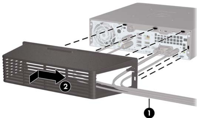
Slika 5-22 Ugrađivanje poklopca porta
