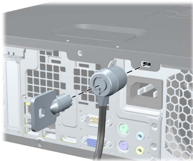
Abbildung C-1 Anbringen einer Kabel-Diebstahlsicherung
