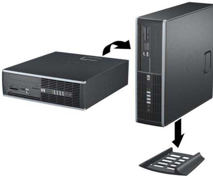
Abbildung 2-6 Umwandeln des Desktop-Systems in ein Tower-System
