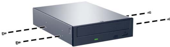
Abbildung 2-24 Installieren von Führungsschrauben am optischen Laufwerk
