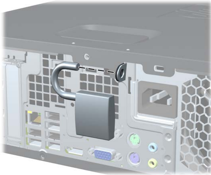
Abbildung C-2 Anbringen eines Vorhängeschlosses
