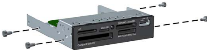
図 3-29 ガイド用ネジの取り付け (図はメディア カード リーダー)
