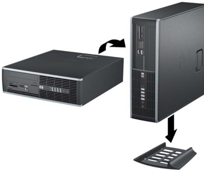
図 2-6 横置きから縦置きへの移行
