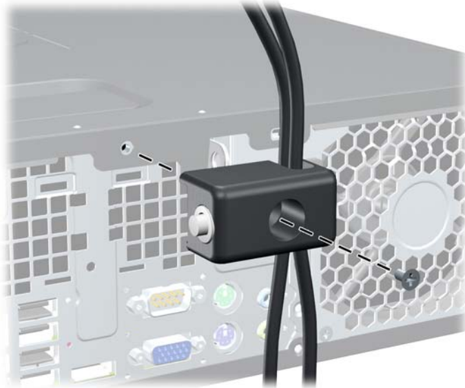
図 C-8 シャーシへの錠の取り付け
