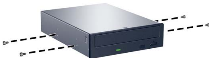
図 2-24 オプティカル ドライブへのガイド用ネジの取り付け
