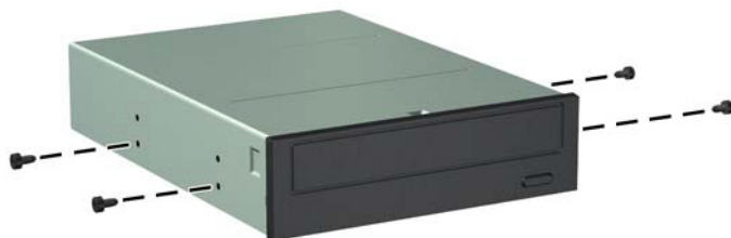
図 3-22 オプティカル ドライブへのガイド用ネジの取り付け
