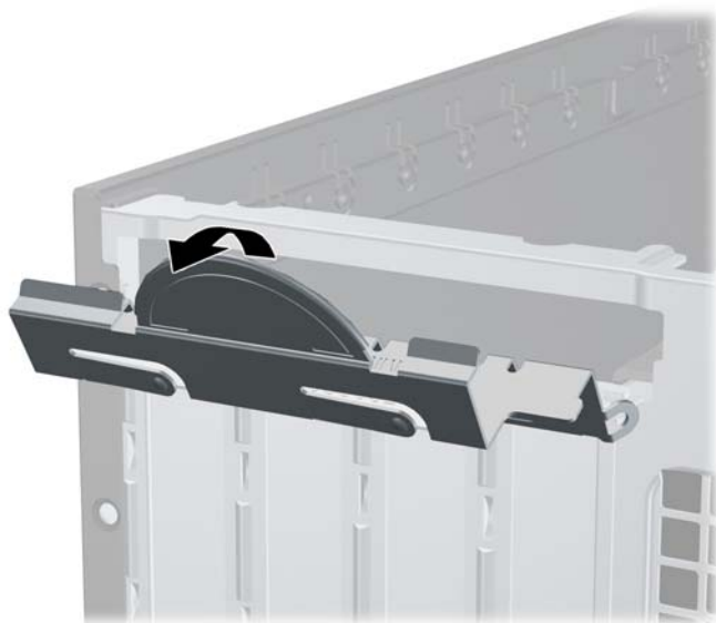
図 2-11 拡張スロットの固定ラッチを開く
