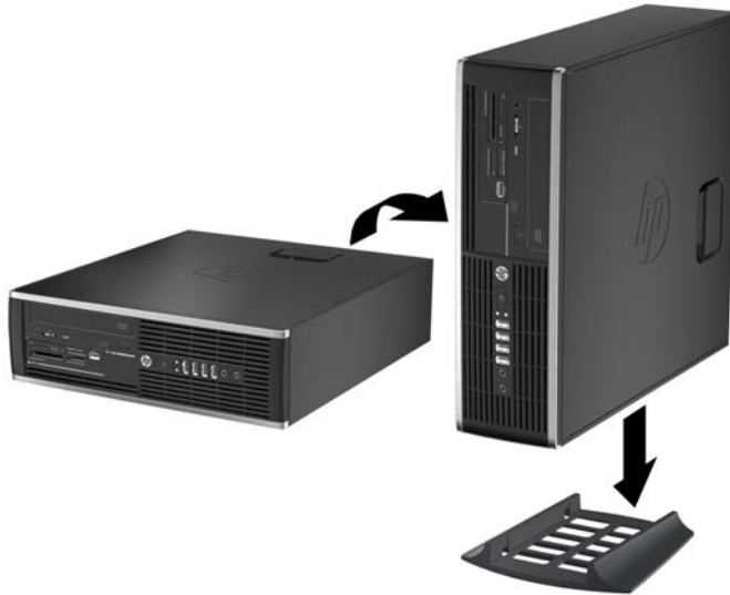
図 3-6 横置きから縦置きへの移行
