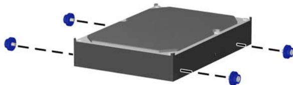
図 2-37 ハードディスク ドライブのガイド用ネジの取り付け
