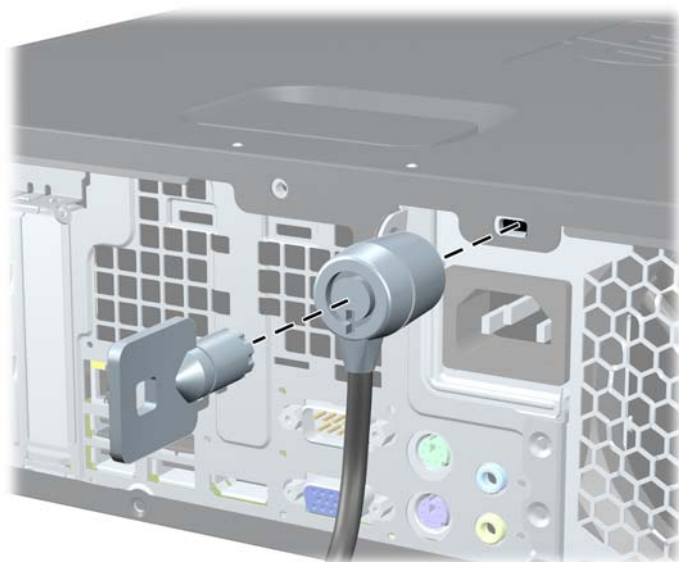
図 C-1 ロック ケーブルの取り付け
