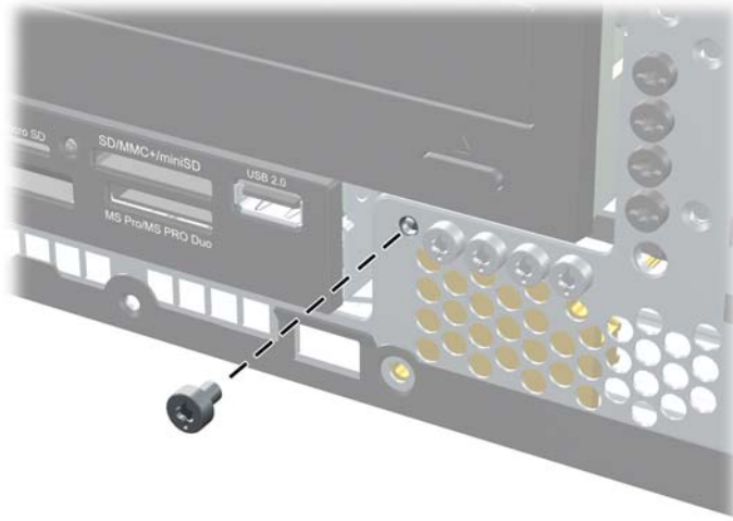
圖示 C-11 取回前面板安全固定螺絲
