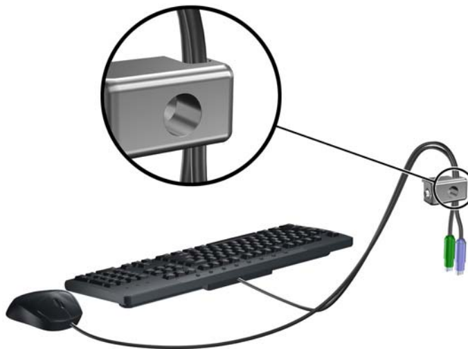
圖示 C-7 穿過鍵盤及滑鼠纜線
