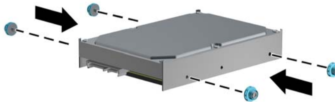
圖示 3-37 安裝硬碟機導引螺絲
