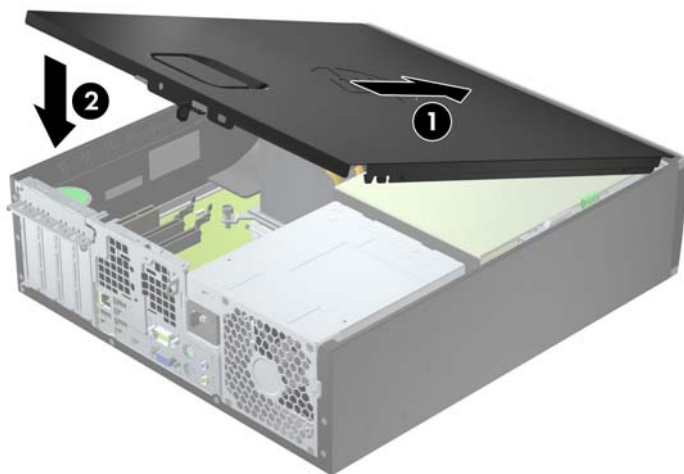
圖示 3-2 裝回電腦存取面板
