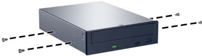
圖示 2-24 將導引螺絲鎖入光碟機
