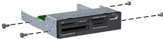
圖示 3-29 安裝導引螺絲（所示為媒體讀卡機）
