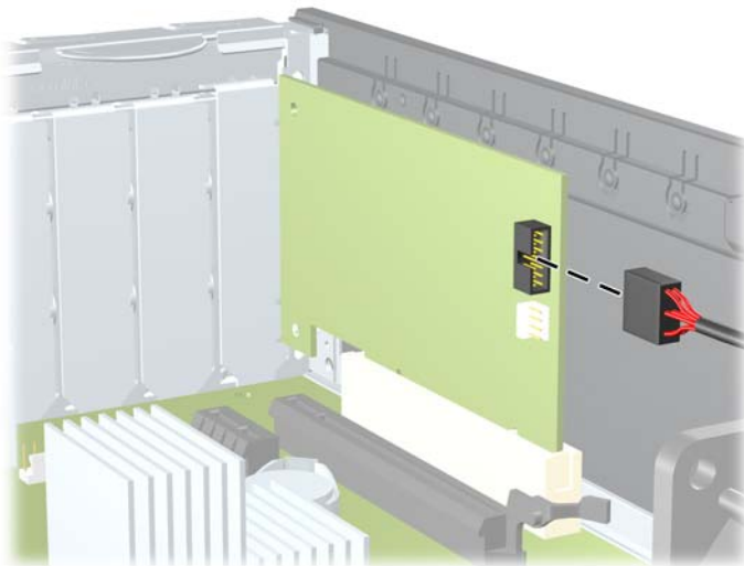
圖示 2-30 拔除讀卡機 1394 纜線
