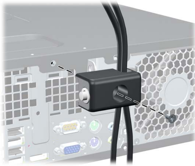
圖示 C-8 將鎖安裝到機箱
