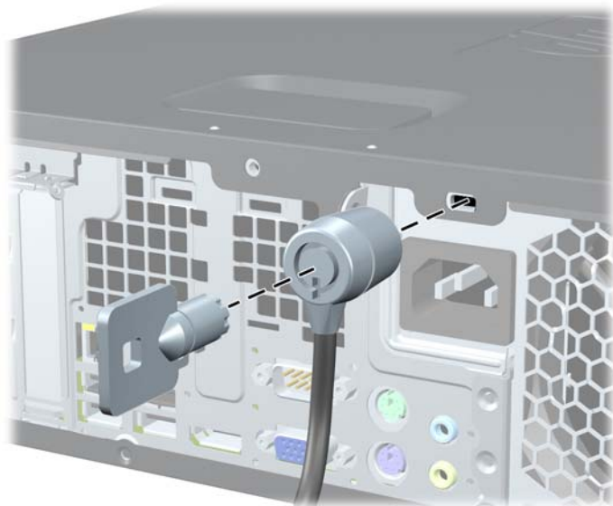
圖示 C-1 安裝纜線鎖
