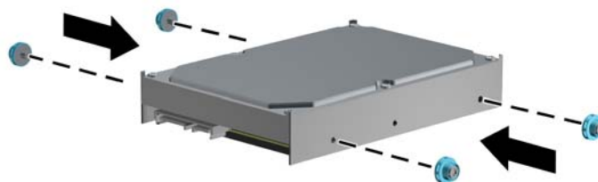
Figura 3-37 Instalación de los tornillos guía en la unidad de disco duro
