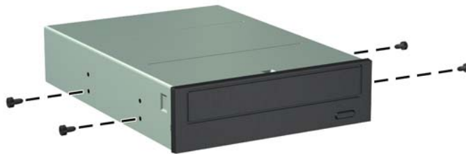
Figura 3-22 Instalación de tornillos guía en la unidad óptica
