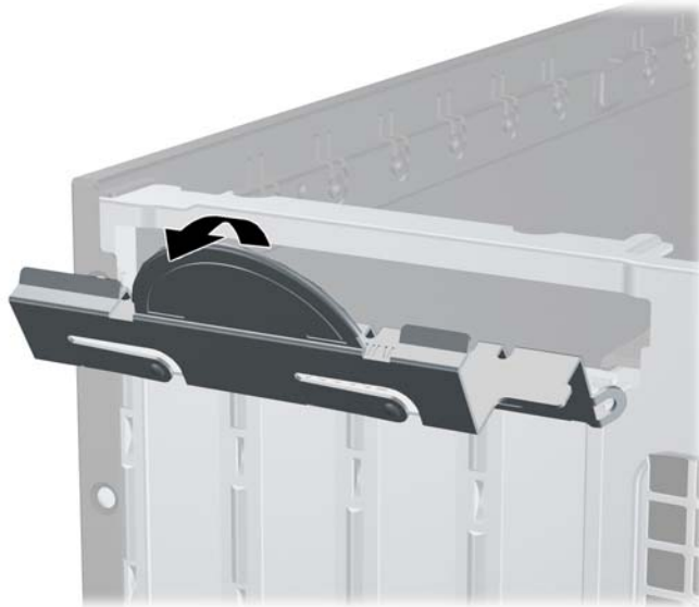
Figura 3-10 Apertura del pestillo de la ranura de expansión
