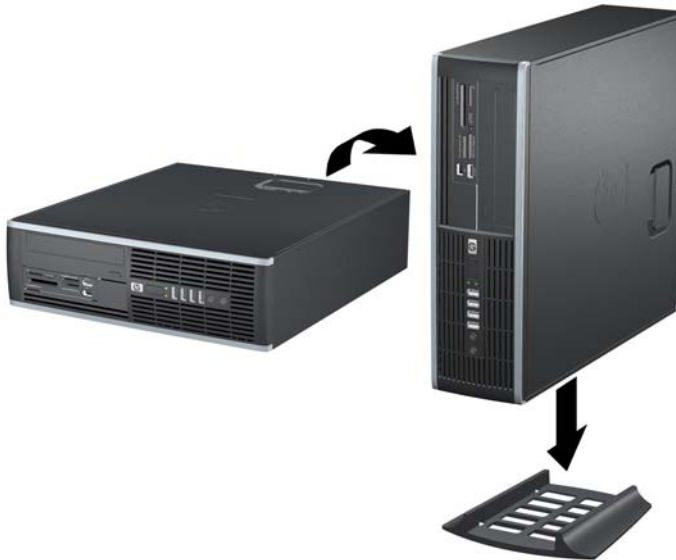
Figura 2-6 Cambio de configuración de desktop para torre
