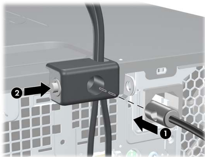
Figura C-9 Activación del bloqueo
