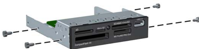
Figura 3-29 Instalación de tornillos guía (se muestra un lector de tarjetas multimedia)
