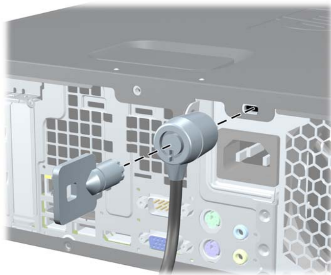
Figura C-1 Instalación de un bloqueo de cable
