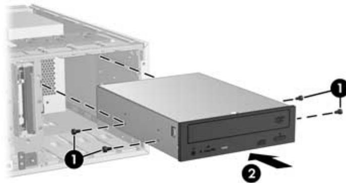
4. Alinhe os parafusos aos marcos no compartimento da unidade e deslize delicadamente a unidade no compartimento até que se encaixe no lugar (2).
