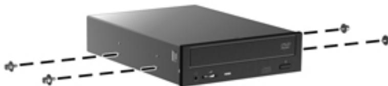
4. Alinhe os parafusos com as ranhuras no compartimento da unidade e deslize delicadamente a unidade no estojo. Deslize a unidade completamente até ela encaixar no lugar.
