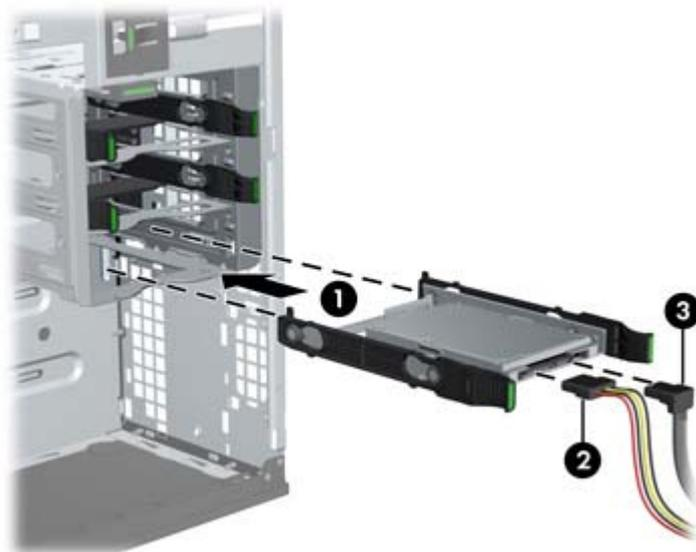
5. Conecte o cabo de alimentação (2) e o cabo de dados (3) na unidade de disco rígido.
