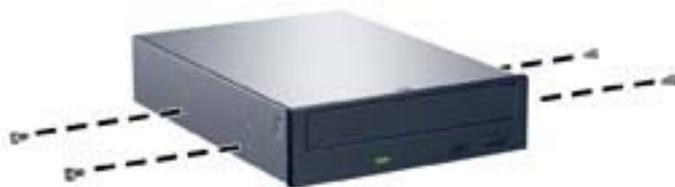
5. Posicione os parafusos-guia na unidade nos slots J do compartimento. Em seguida, deslize a unidade na direção frontal do computador até que ela trave no local.
